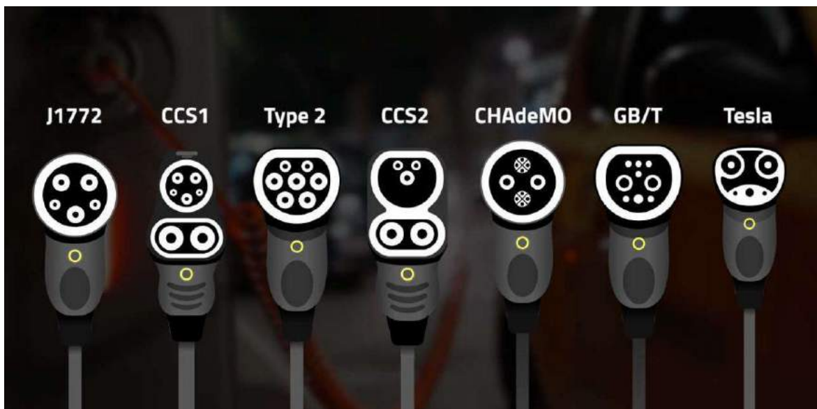
Рисунок 1.3 Типи роз'ємів підключення конектора
