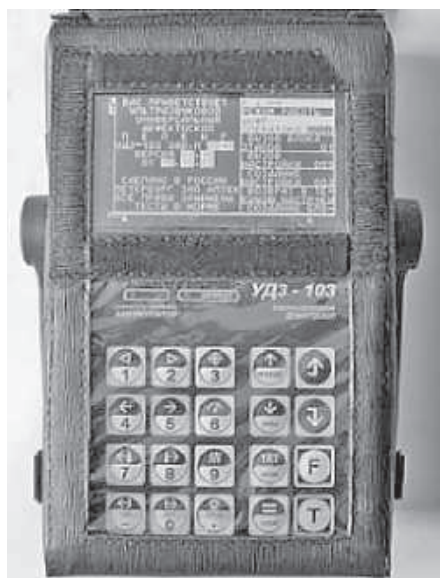
Рисунок 3.1 – Ультразвуковий дефектоскоп УДЗ–103
