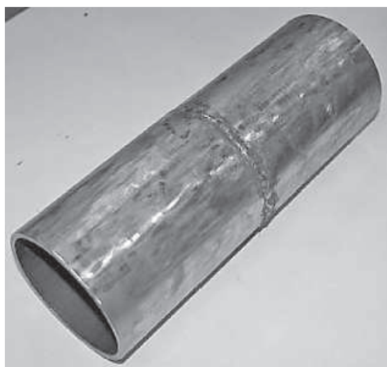
Рисунок 3.4 – Зразок трубного зварного з'єднання
