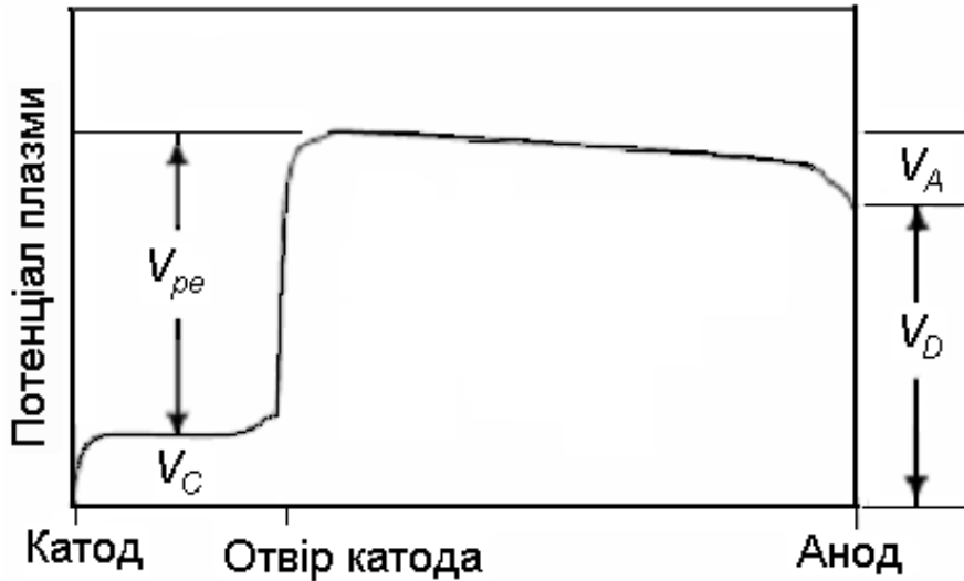
Рис. 8. Потенціал газорозрядної плазми від катода до анода
