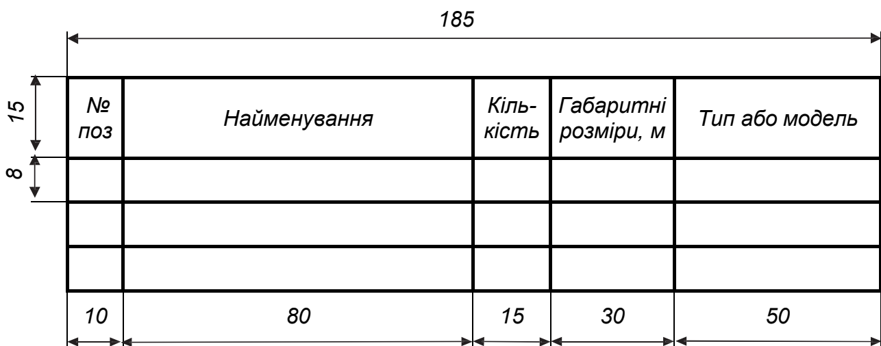
Рисунок В.2 – Форма специфікації обладнання для технологічних планувань виробничих зон і діляниць
