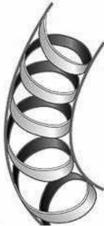
Рис. 4. Траєкторія руху робочої рідини в гідромуфті [3]
