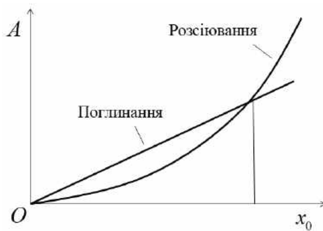
Рис. 39. Робота збудовальної сили і сили демпфірування за один період
