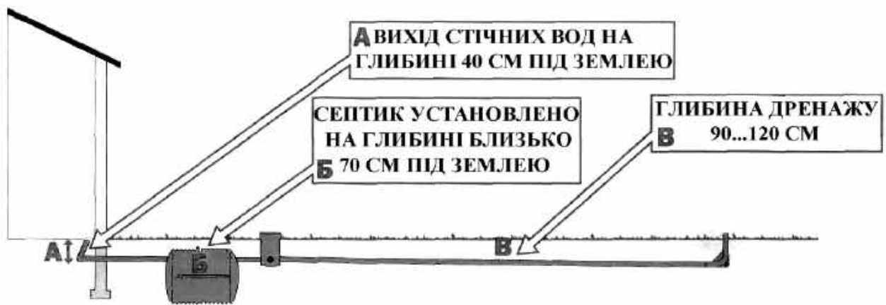
Рисунок 3. 8 – Схема «ідеального» встановлення ЛОС
