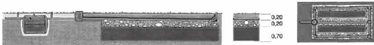
Рисунок 3.40 – Схема дренажу із заміною ґрунту під ним
