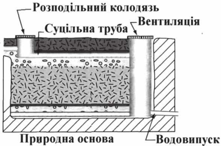
Рисунок 3.47 – Бічний переріз вертикального піщаного фільтра
