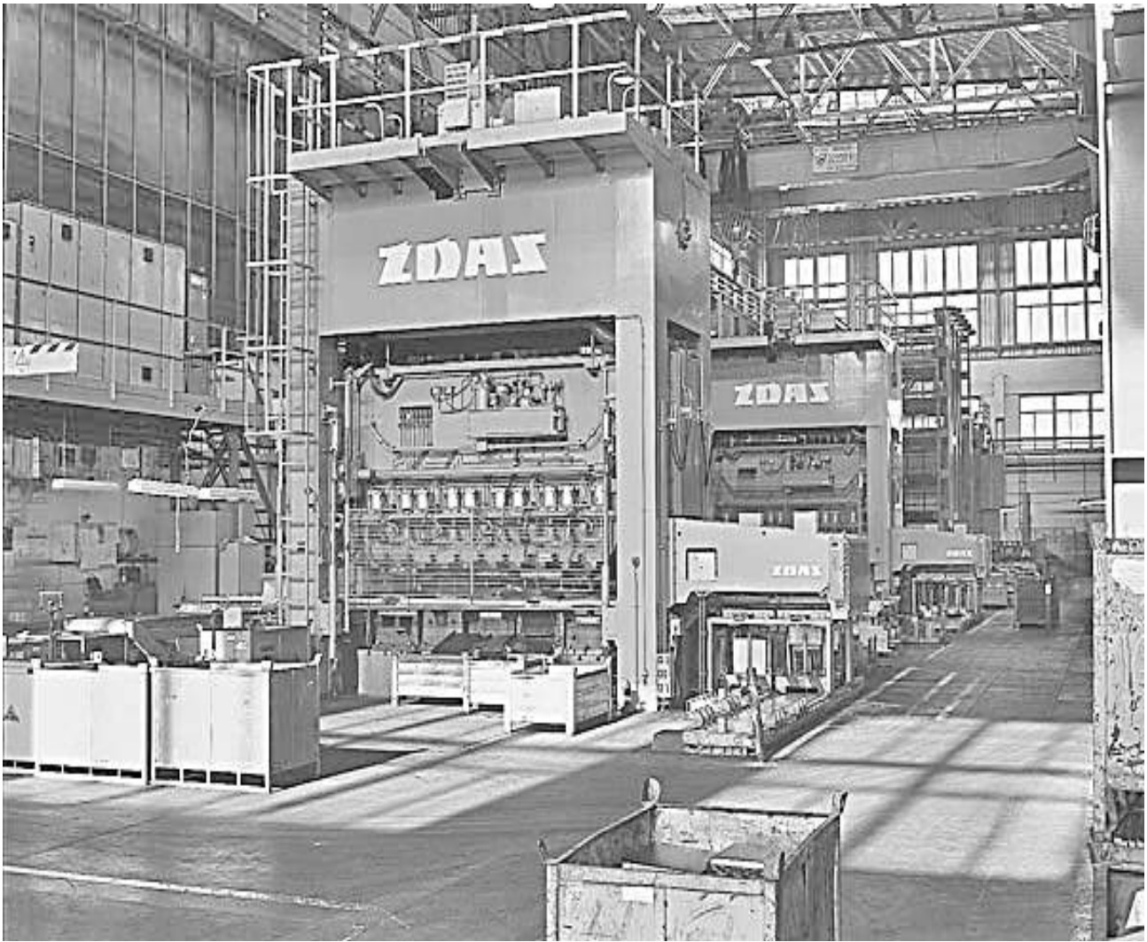
Рисунок 60 – Лінія механічних пресів для багатоперехідного послідовного штампування великогабаритних автокузовних панелей у великосерійному виробництві [19]
