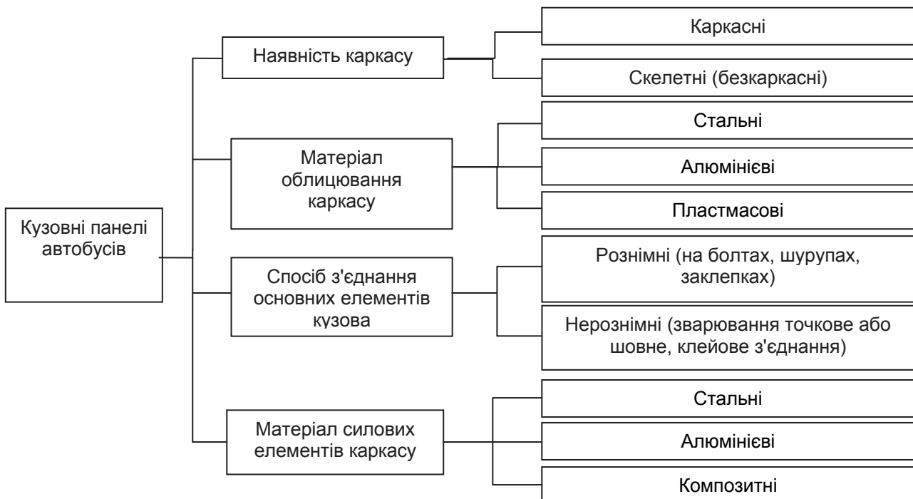
Рисунок 4 – Класифікація автокузовних панелей автобусів [1]
