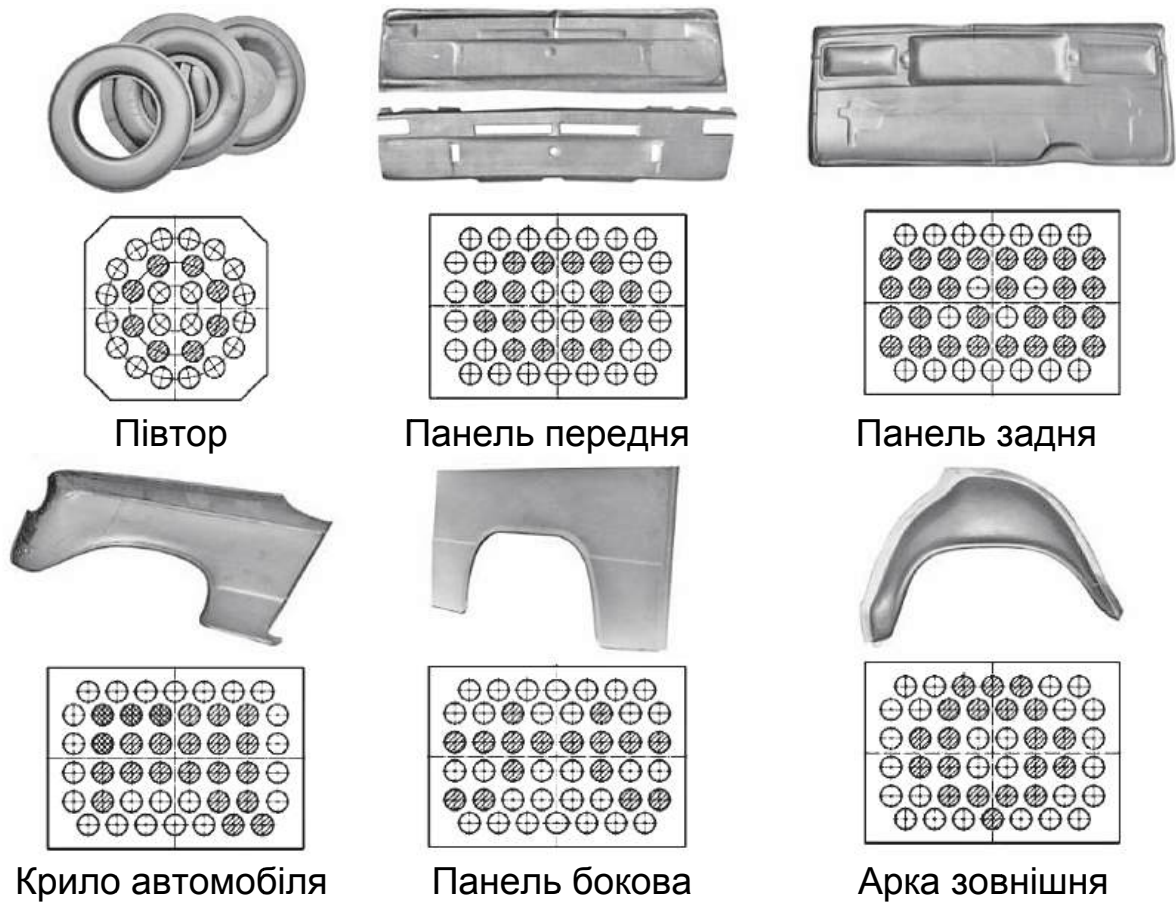
Рисунок А.3 – Деталі: заштриховані кола – розрядні порожнини, в яких проводиться розряд одного контуру (одиначне штрихування) і двох контурів (подвійна штриховка)
