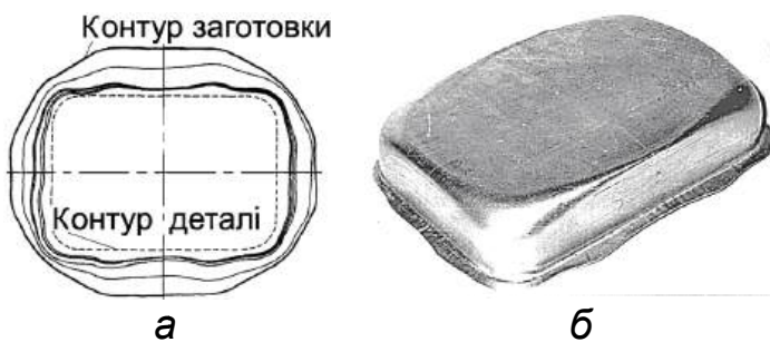
Рисунок 20 – Послідовні положення кромки фланця при витяжці коробчастої деталі (а) і вигляд ділянки сполучення двох бортів і дна перед початком другого етапу формоутворення (б)
