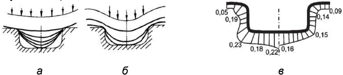
Рисунок 29 – Послідовні положення заготовки при формоутворенні прямокутного рифта і розподіл деформацій стоншення при навантаженні: а – загальному; б – локальному; в – розподіл деформацій стоншення для цих варіантів (зліва – для загального навантаження, справа – для локального навантаження). Матеріал – АМцАМ, лист товщиною 2,0 мм
