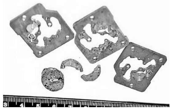
Рисунок 3.23 – Деталі годинникових механізмів після термоімпульсної обробки
