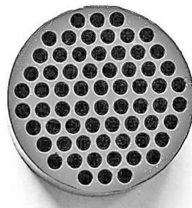
Рисунок 3.31 – Корпуси детонаторів зі сплаву АЛ9. Округлення кромки на перетині отвору з різальною поверхнею
