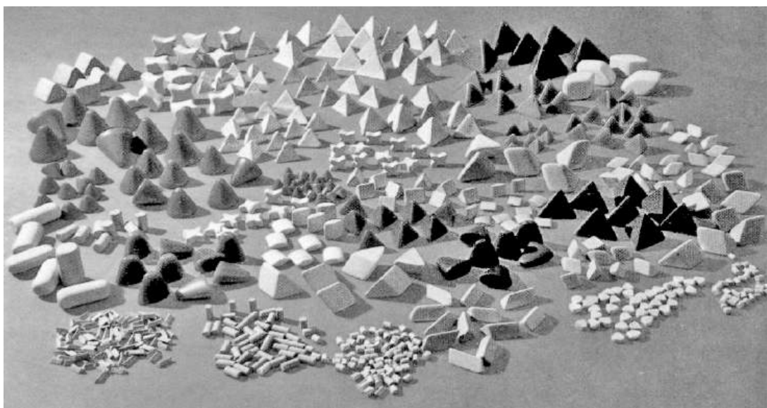
Рисунок 3.13 – Типові абразивні тіла, застосовувані при галтуванні
