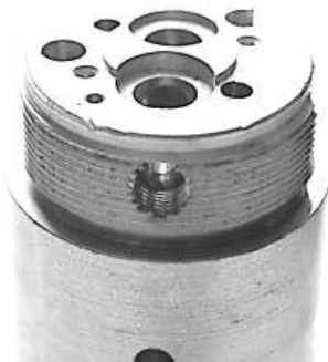
Рисунок 3.31 – Корпуси детонаторів зі сплаву АЛ9. Округлення кромки на перетині отвору з різальною поверхнею
