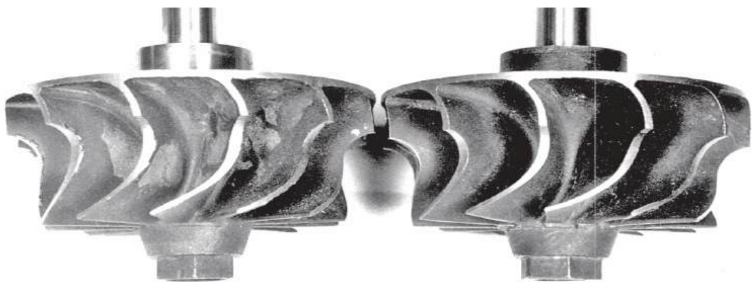
Рисунок 3.29 – Колеса турбіни з жароміцного сплаву до і після термоімпульсної обробки
