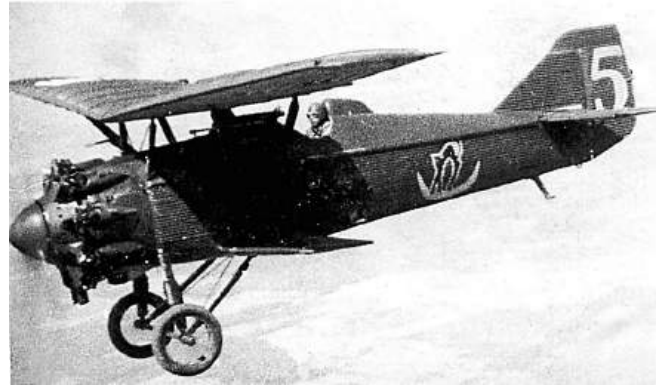
Рисунок 3.42 – Суцільнометалевий винищувач І-4
