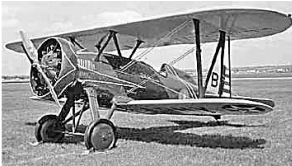
Рисунок 3.39 – Палубний винищувач Boeing P-12 з двигуном повітряного охолодження
