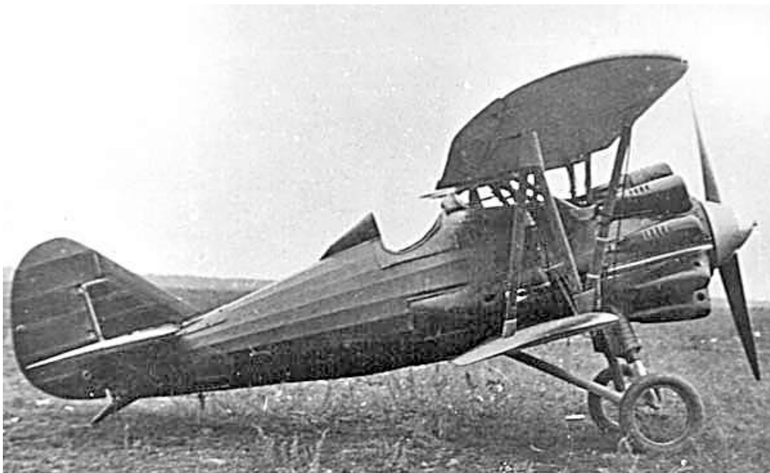
Рисунок 3.43 – Радянський винищувач-півтораплан – легкий маневрений змішаної дерево-метало-полотняної конструкції
