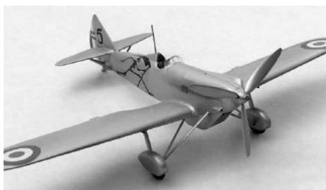
Рисунок 3.30 – D.500 (а) і D.510 (б) – одномісні французькі винищувачі з відкритою кабіною і невисувним шасі
