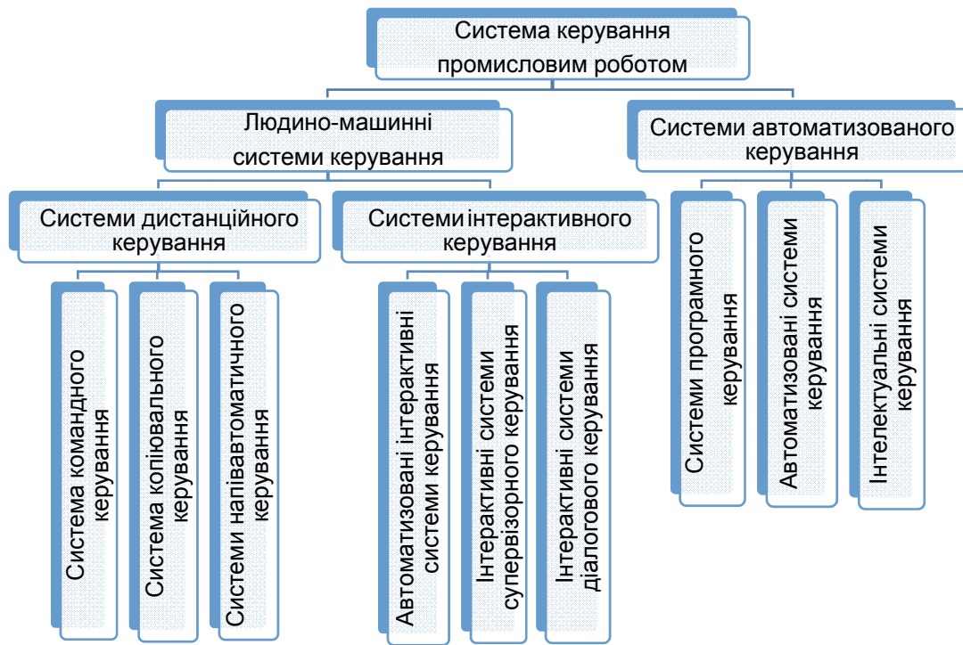
Рис. 4.1. Класифікація систем керування промисловими роботами
