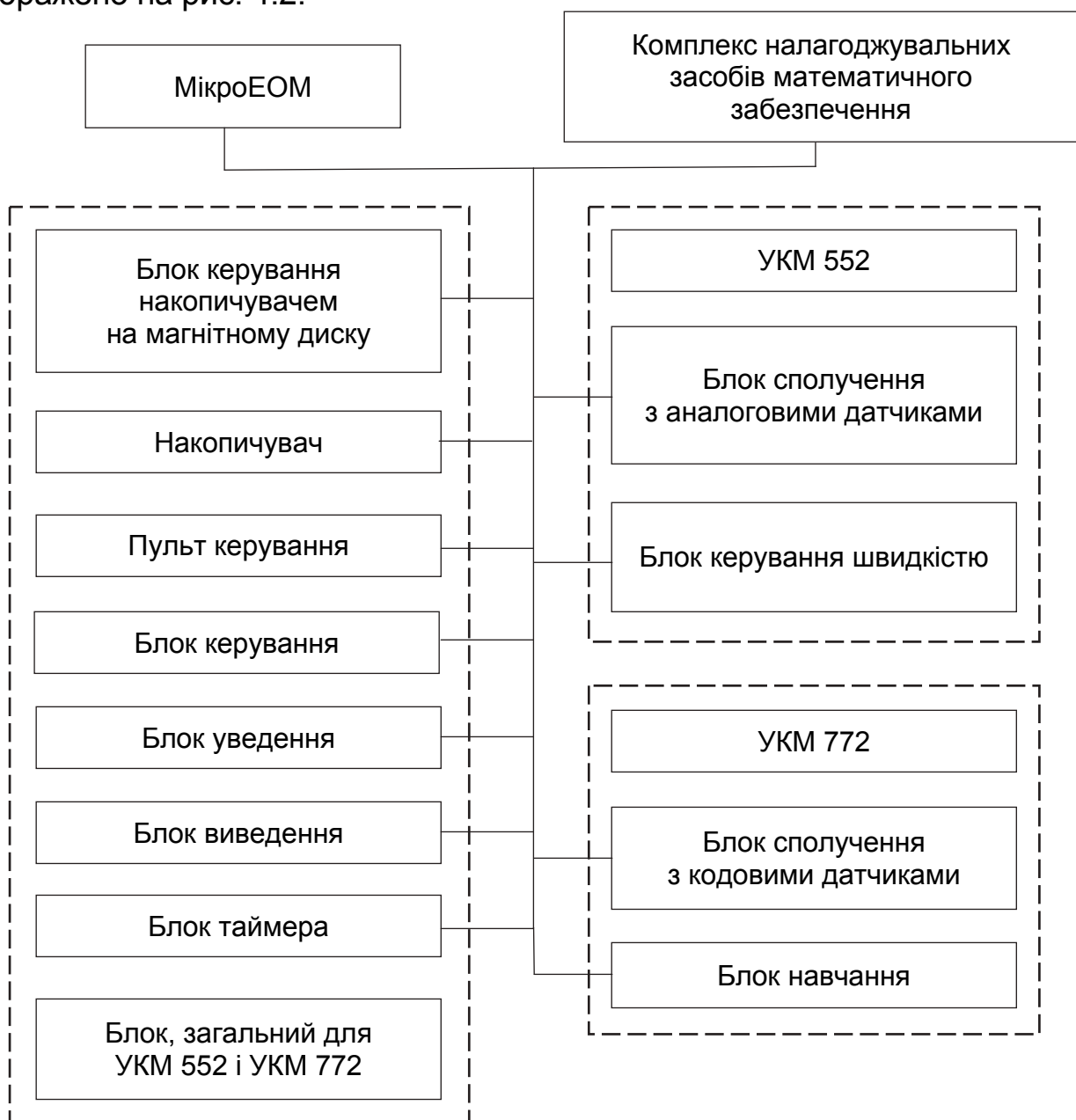
Рис. 4.2. Спрощена структурна схема пристроїв керування УКМ 552 і УКМ 772
