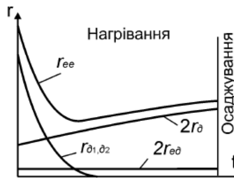
Рис. 2.16. Змінення електричного опору при стиковому зварюванні
