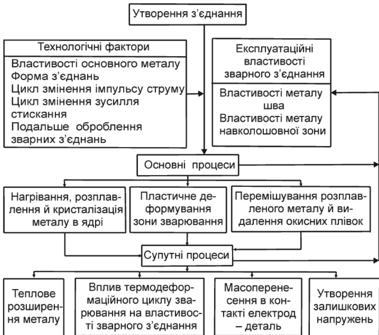
Рис. 2.6. Основні й супутні процеси при утворенні контактного з'єднання
