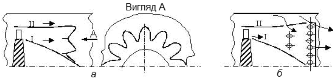
Рис. 8.4. Камера змішування ТРДД: а – пелюсткового типу; б – струминного типу
