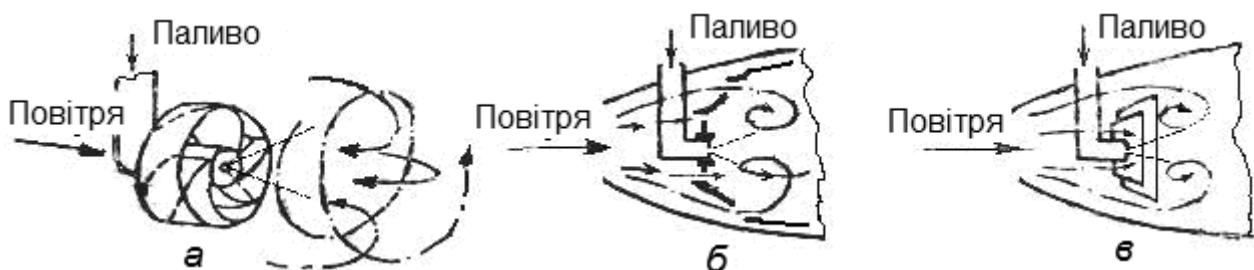
Рис. 6.5. Стабілізатори горіння: а – лопатковий; б – струминний; в – зривний
