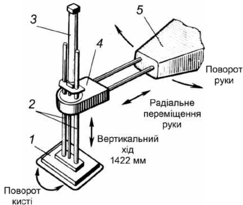
Рисунок 2.22 – Вакуумний захоплювач робота Unimate
