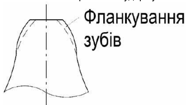
Рис. 99. Кромковий удар зубів
