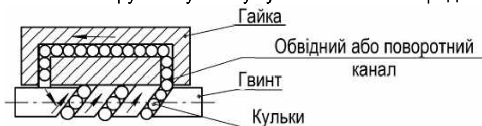
Рис. 66. Конструктивна схема кулькогвинтової передачі
