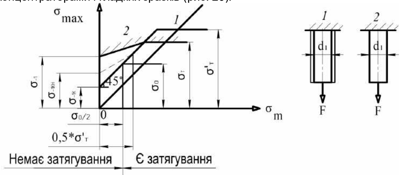
Рис. 20. Діаграми граничних напружень для зразків з концентраторами 1 і гладких зразків 2
