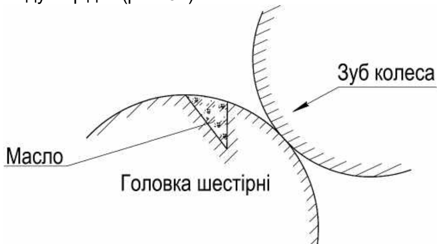
Рис. 94. Мікротріщини на головці шестерні
