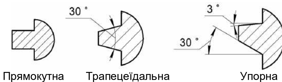
Рис. 59. Типи різей, що застосовуються в передачах гвинт – гайка з тертям ковзання
