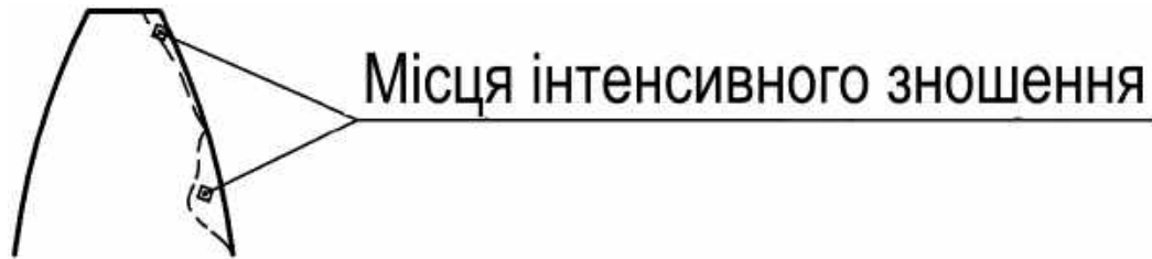
Рис. 97. Місця інтенсивного зношення зубів
