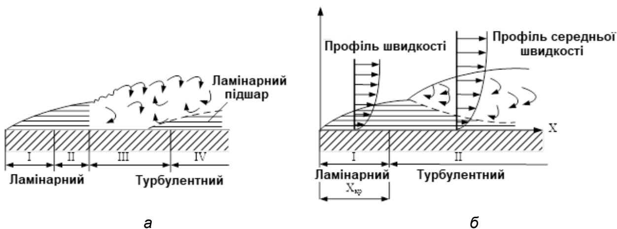
Рисунок 5.2 – Структура примежового шару: а – за експериментальними даними; б – спрощена модель
