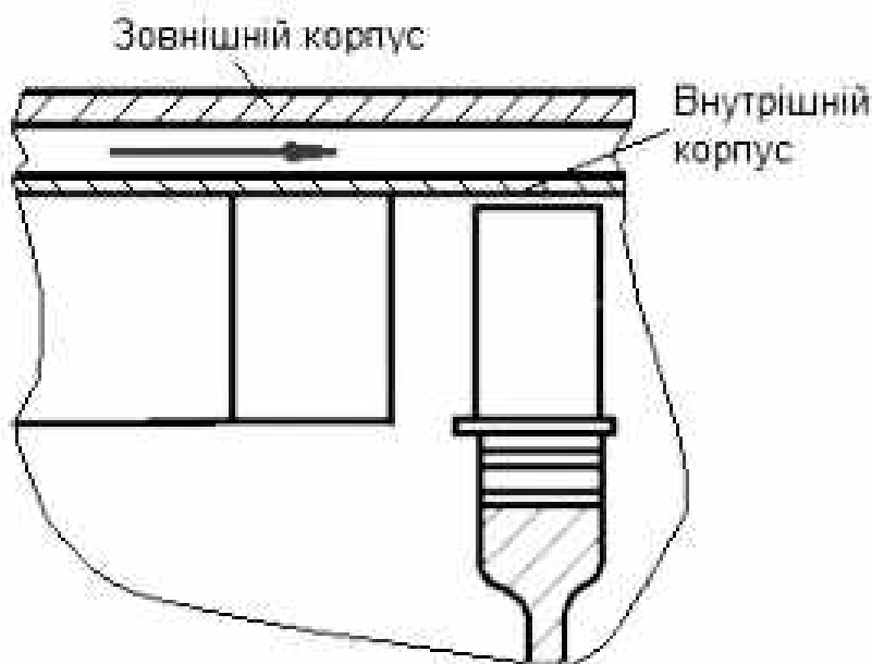
Рисунок 2.10 – Схема корпусу турбіни
