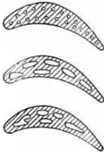
Рисунок 3.8 – Схема охолодження робочих лопаток з дворядним розташуванням каналів
