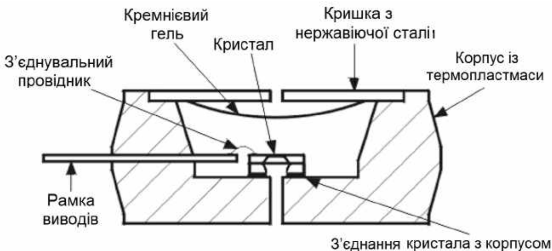
Рис. 4.5. Поперечний переріз базового корпусу датчика MPX диференціального тиску
