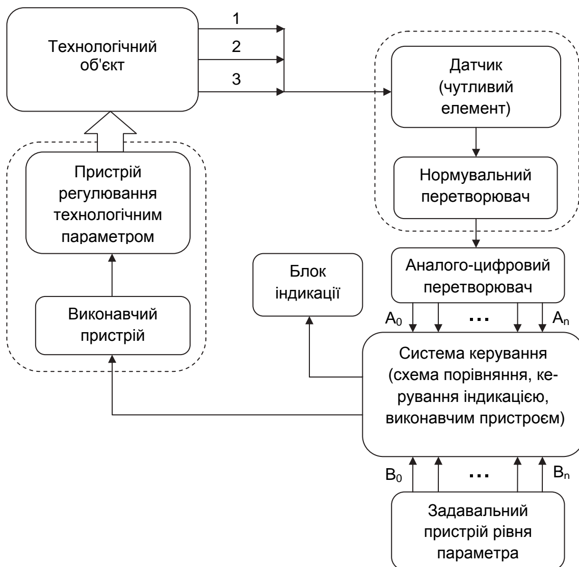
Рис. 1.2. Узагальнена структурна схема системи автоматизації технологічного об'єкта: 1 – сигналізуючі параметри; 2 – контрольовані параметри; 3 – регульовані параметри
