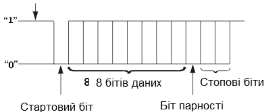
Рис. 7.4. Формат повідомлення в стандарті RS-232
