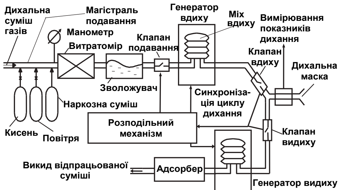
Рис. 1.22. Структура апарату ШВЛ
