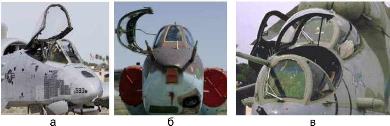
Рис. 7.8. Ліхтар кабіни літака-штурмовика (а, б) та бойового вертольота (в)
