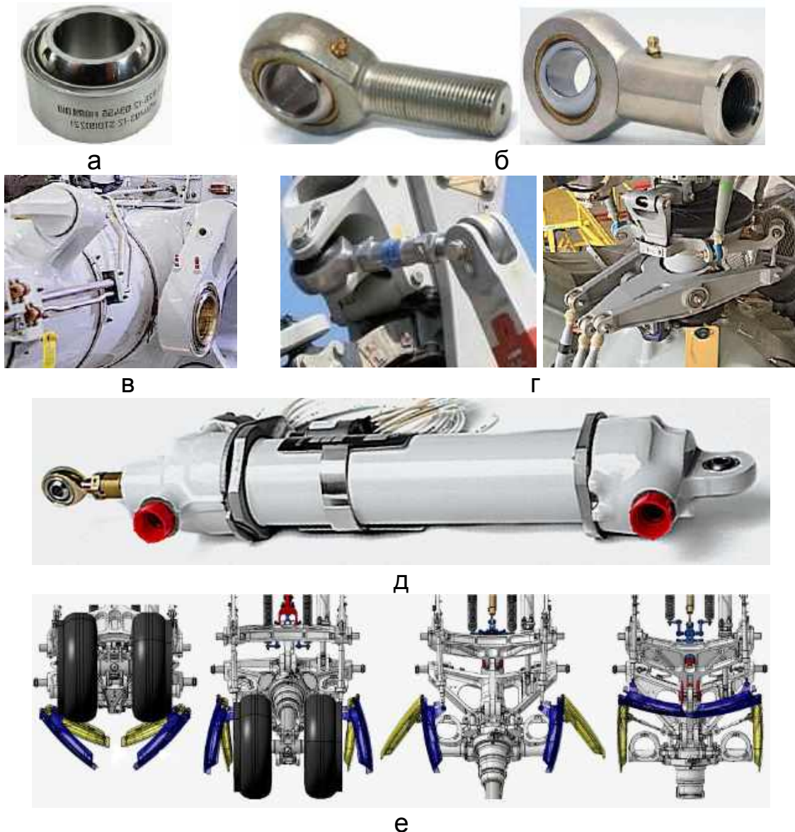
Рис. 9.32. Приклади розташування сферичних підшипників ковзання та шарнірних головок у механічній системі керування літальним апаратом, стояках і тягах ступок шасі пасажирського літака
