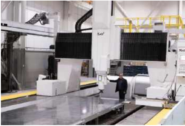
Рис. 2.14. Загальний вигляд: а – фрезерного верстата моделі MAG U5-1500; б – виклеувальної прес-форми після п'ятикоординатного оброблення
