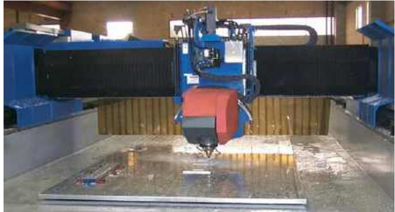
Рис. 10.15. Верстат моделі MAG HYPERMACH з рухливим порталом: а – компонування верстата; б – оброблення монолітної панелі з плити
