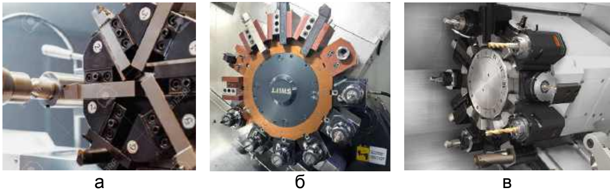
Рис. 3.5. Інструментальні магазини токарних верстатів з ЧПК: а – різцетримач на шість позицій; б, в – револьверна головка на 12 позицій
