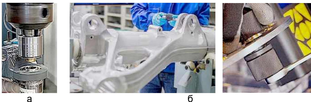
Рис. 9.37. Роликове розкочування сферичних підшипників ковзання з V-подібним пазом на стаціонарному устаткуванні (а) та в обмежених виробничих умовах (б)
