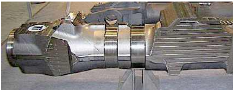
Рис. 9.12. Підготовчі операції оброблення заготовки рами візка шасі пасажирського літака
