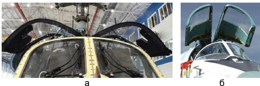
Рис. 7.4. Відкидні частини ліхтаря легкого вертольота (а) та літака-бомбардувальника (б)
