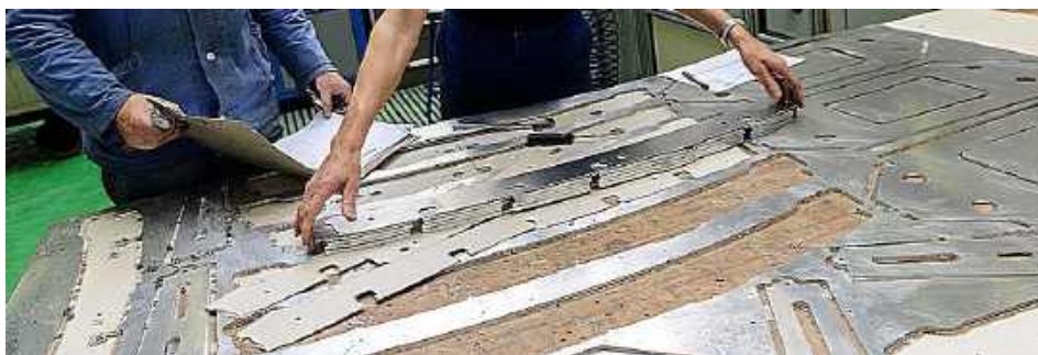
Рис. 2.6. Загальний вигляд листових заготовок після розкроювання
