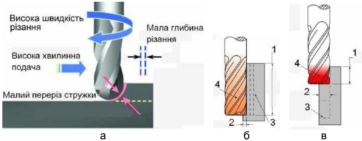
Рис. 10.9. Принцип фрезерування методом HSM та схеми контакту фрези із заготовкою: 1 – ширина фрезерування; 2 – глибина фрезерування; 3 – припуск; 4 – зона нагрівання фрези
