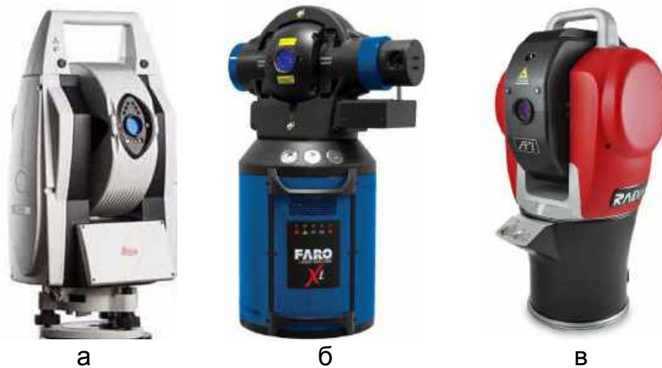
Рис. 1.17. Лазерні трекери моделей: а – Leica AT403; б – FARO ION; в – API Tracker 3
