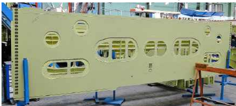
Рис. 5.7. Приклади фітингового стику центроплана (а, в) та крила (б) пасажирського літака середнього класу
