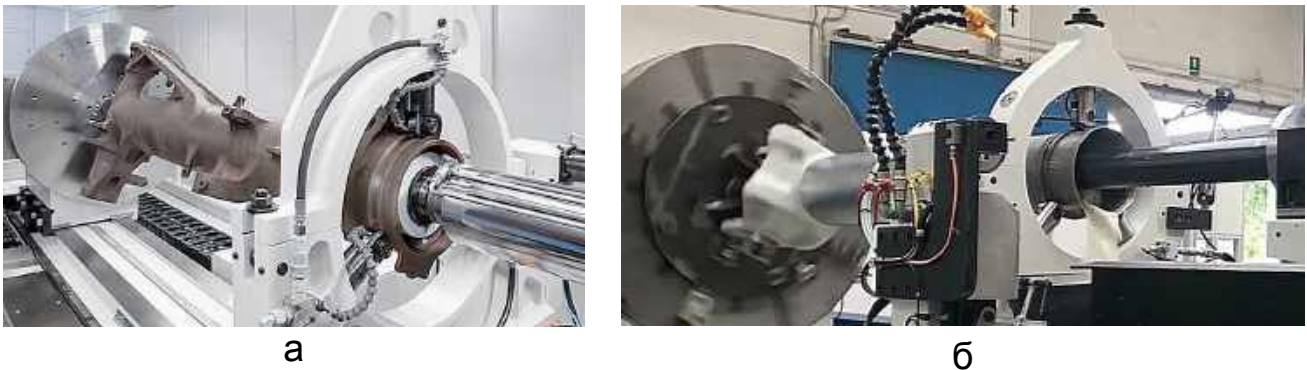
Рис. 9.23. Приклади патронного внутрішнього круглого шліфування головного (а) та амортизаційного (б) стояків шасі пасажирського літака
