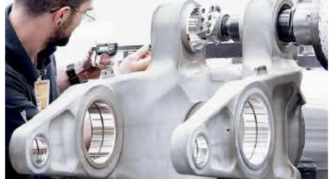
Рис. 9.17. Свердління та розточування отворів у вушках та запресованих втулках стояків шасі пасажирського літака
