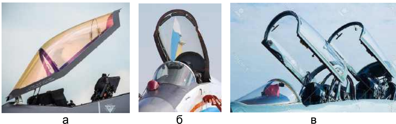
Рис. 7.5. Каркас і скління ліхтаря кабіни надзвукових літаків-випищувачів
