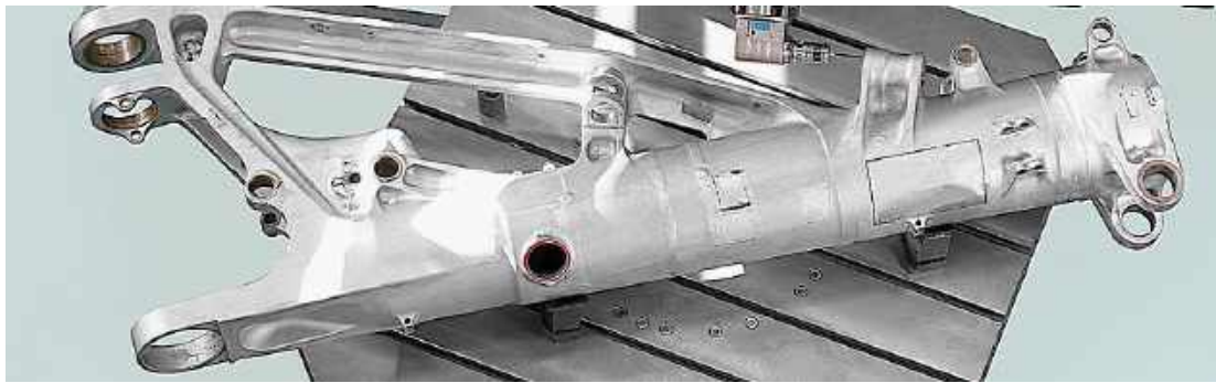
Рис. 9.19. Стояк головного шасі пасажирського регіонального літака
