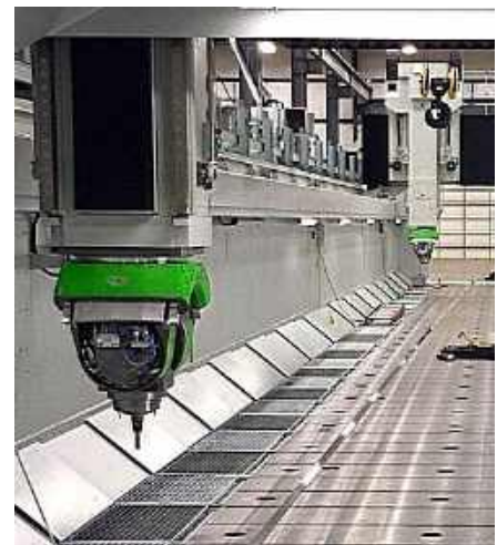
Рис. 10.16. Варіанти компонування верстата моделі Macbormill HSM Aero
