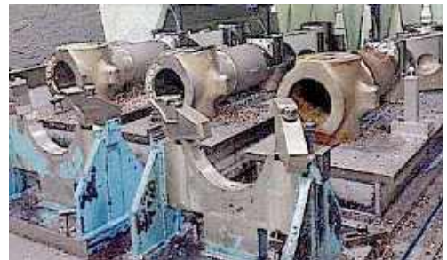
Рис. 9.12. Підготовчі операції оброблення заготовки рами візка шасі пасажирського літака
