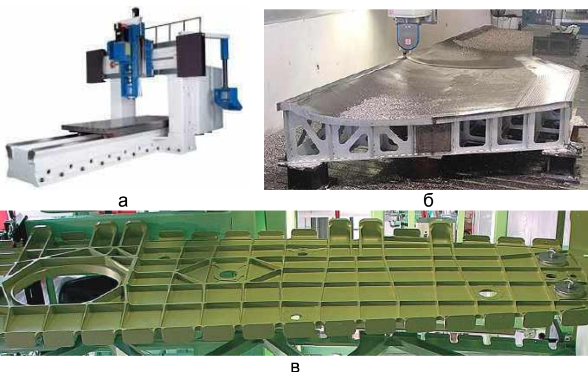
Рис. 2.4. Загальний вигляд: а – верстата з ЧПК моделі ВФ-3М8; б – виклеювальної прес-форми; в – нервюри центроплана
