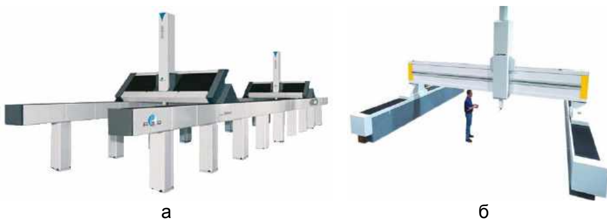
Рис. 1.7. Мостове компонування КВМ: а – з двома порталами; б – спеціалізоване для контролю монолітних панелей
