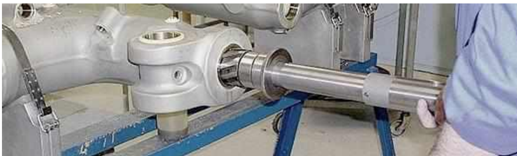
Рис. 9.18. Приклади чистової обробки отворів стояків шасі ручними пневматичними машинами: а, б – розгортання; в – зенкерування
