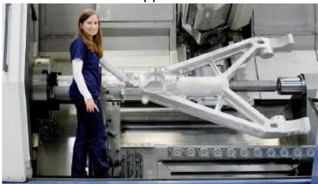
Рис. 9.25. Технологічні можливості багатоопераційних верстатів WFL Millturn: а – оброблення стояка головного шасі на верстаті моделі М65; б – токарна обробка амортизаційного стояка носового шасі; в – позначення переміщень виконавчих механізмів багатоопераційних верстатів WFL Millturn; г – фрезерна обробка вушка амортизаційного стояка; д – спіральне фрезерування рами візка головного шасі; е – зубонарізання для рульового механізму носового стояка; ж – приклад закріплення стояка носового шасі на планшайбі та пінолі задньої бабки верстата; и – приклад закріплення стояка носового шасі на планшайбі та люнеті верстата
