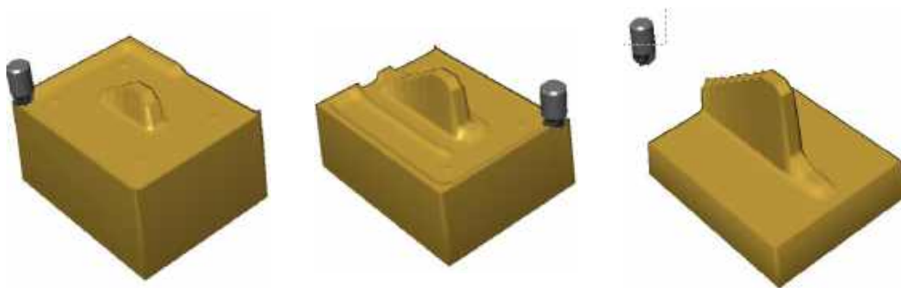
Рис. 10.8. Поетапна візуалізація процесу фрезерування
