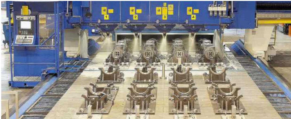
Рис. 9.16. Групова фрезерна обробка амортизаційних стояків шасі літака
