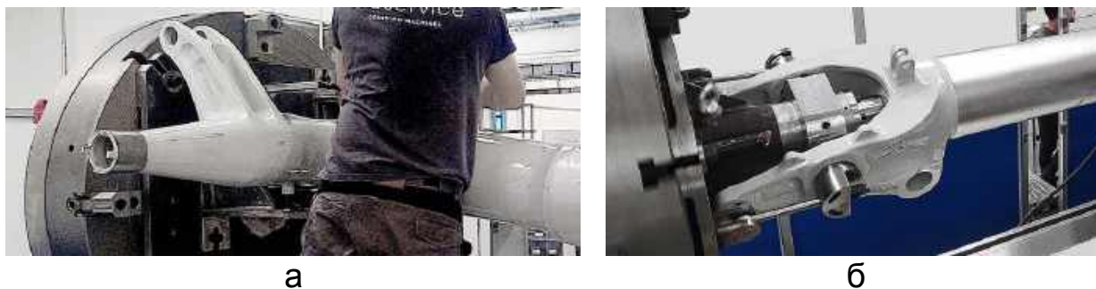
Рис. 9.28. Спеціальне технологічне оснащення для базування та закріплення стояків шасі літака на планшайбі багатоопераційних верстатів WFL Millturn
