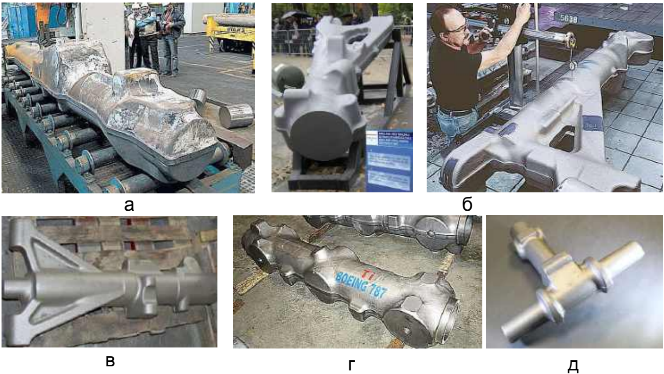
Рис. 9.4. Штамповані титанові заготовки деталей шасі: а – носового стояка аеробуса; б – стояка головного шасі регіонального пасажирського літака; в – носового стояка винищувача; г – рами візка регіонального пасажирського літака; д – штока та маточини носового стояка літака-винищувача
