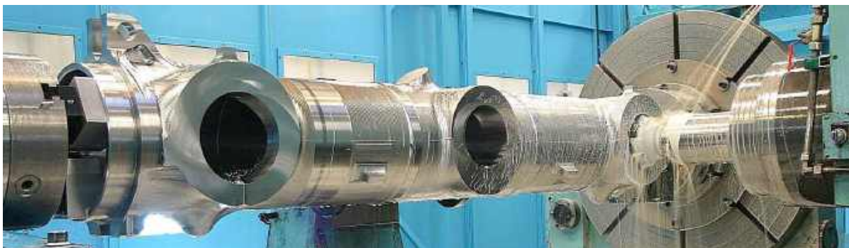
Рис. 9.15. Етап зенкерування отворів рами візка шасі пасажирського літака
