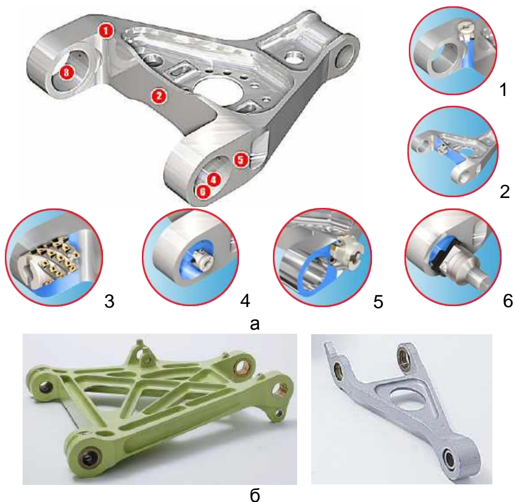
Рис. 9.20. Схема послідовності оброблення (а) та загальний вигляд деталей шліц-шарніра (б) стояка шасі: 1 – контурне фрезерування галтелі, 2, 3 – площин; 4 – свердління отворів; 5 – фрезерування площин; 6 – розточування отворів
