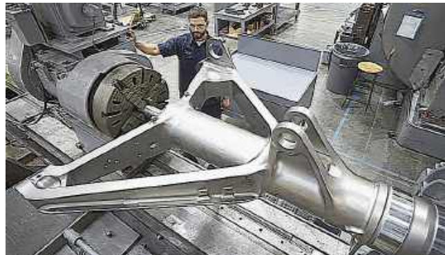
Рис. 9.14. П'ятикоординатна одномісна фрезерна обробка заготовки стояка шасі
