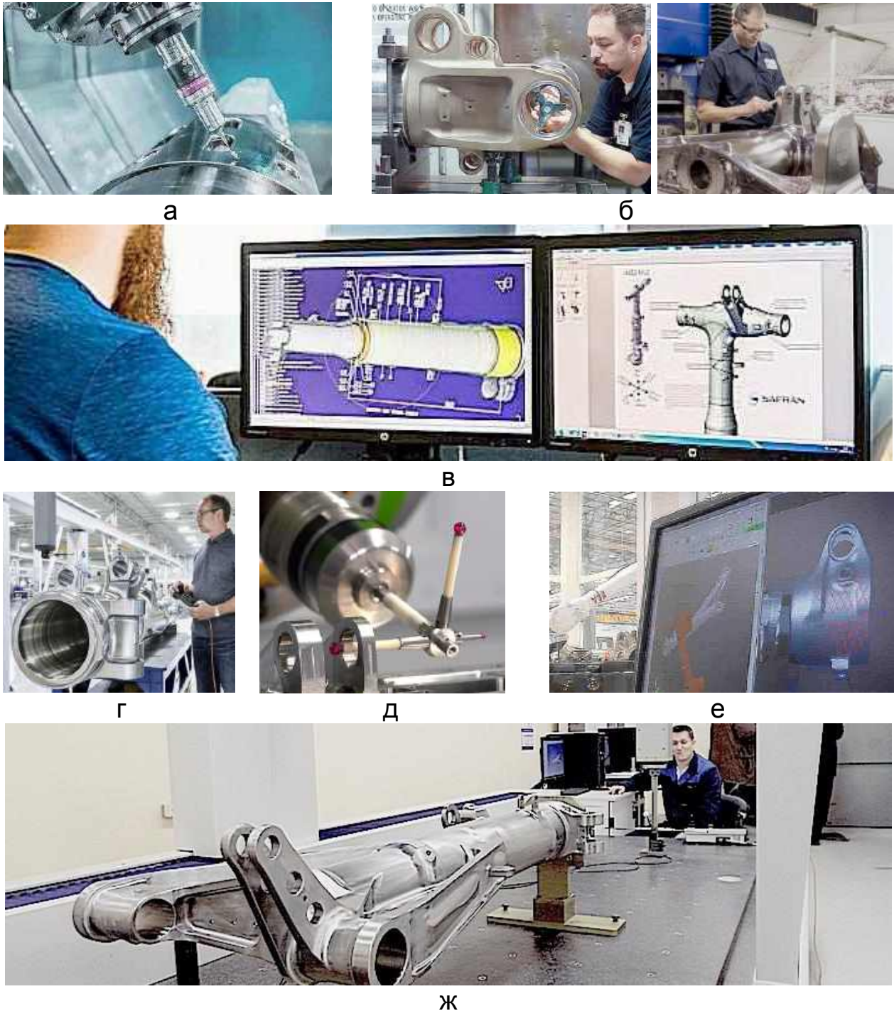
Рис. 9.30. Контроль геометричних параметрів корпусу стояка шасі літака
