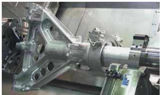
Рис. 9.25. Технологічні можливості багатоопераційних верстатів WFL Millturn: а – оброблення стояка головного шасі на верстаті моделі М65; б – токарна обробка амортизаційного стояка носового шасі; в – позначення переміщень виконавчих механізмів багатоопераційних верстатів WFL Millturn; г – фрезерна обробка вушка амортизаційного стояка; д – спіральне фрезерування рами візка головного шасі; е – зубонарізання для рульового механізму носового стояка; ж – приклад закріплення стояка носового шасі на планшайбі та пінолі задньої бабки верстата; и – приклад закріплення стояка носового шасі на планшайбі та люнеті верстата
