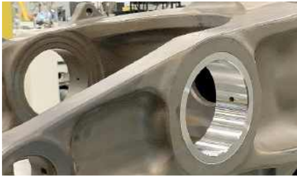
Рис. 9.17. Свердління та розточування отворів у вушках та запресованих втулках стояків шасі пасажирського літака
