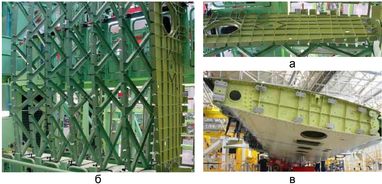
Рис. 5.11. Приклади монолітних нервюр центроплана (а, б) та крила (в) з плит
