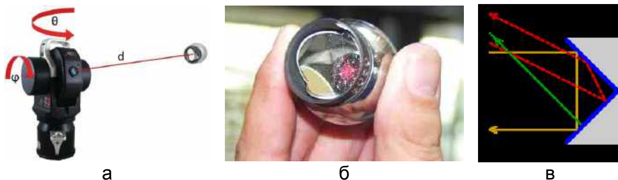
Рис. 1.15. Принцип координатних вимірювань лазерним трекером
