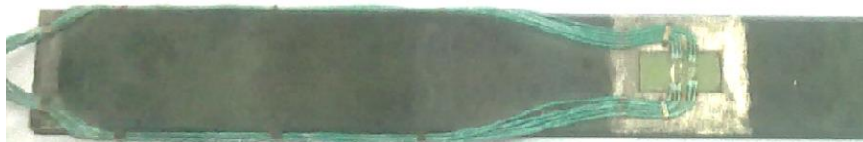
Рис. 2 – Градуювальна балка з нанесеними тензорезисторами
