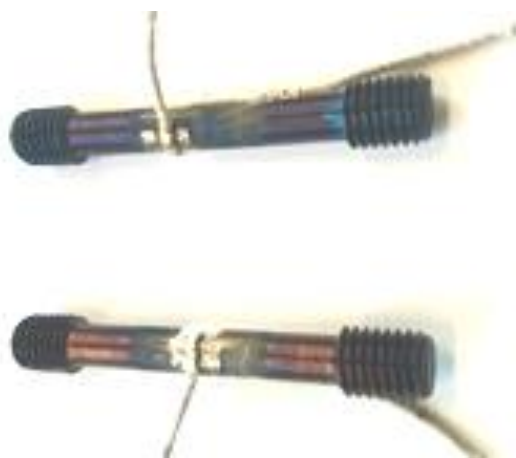
Рис. 2 – Зразок препарований тензометричною розеткою
