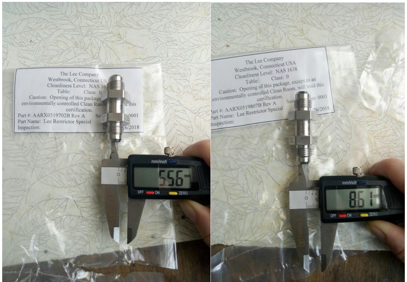
Рисунок 22 – Вимір внутрішнього діаметру дроселів
