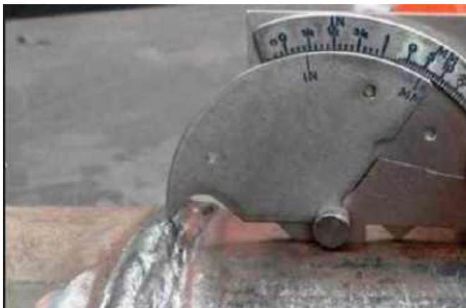
Рис. 2.14. Вимірювальний контроль у виробничих умовах: а – вимірювання ширини стикового шва; б, г, д – вимірювання посилення стикового шва; в – вимірювання посилення кутового шва; е – стандартний комплект візуального і вимірювального контролю
