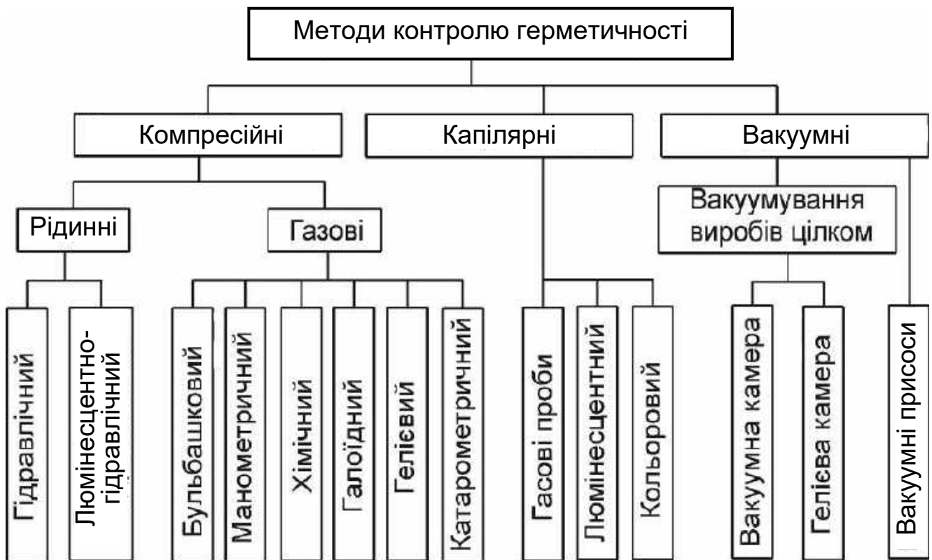
Рис. 3.1. Класифікація методів контролю герметичності
