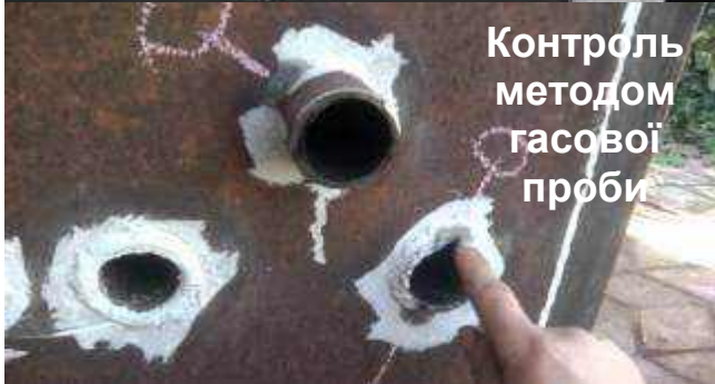
Рис. 2.1. Неруйнівний контроль виготовлення зварних з'єднань
