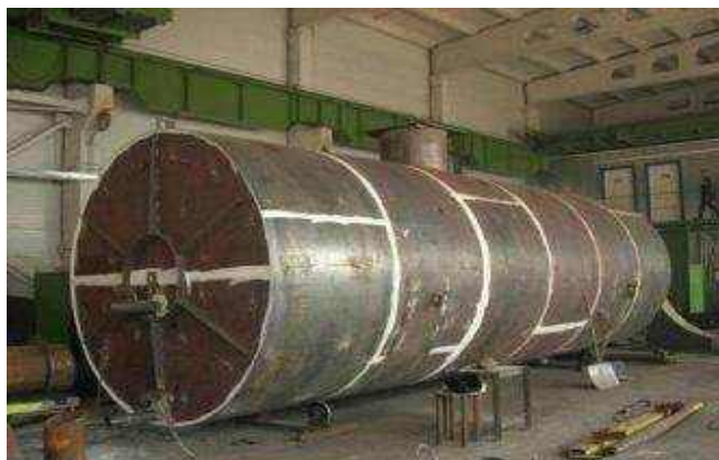
Рис. 3.1. Контроль герметичності методом гасової проби
