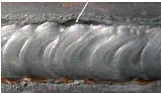
Рис. 1.8. Підріз зони сплавлення
