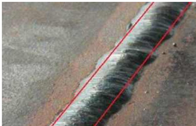
Рис. 1.19. Нерівномірна ширина зварного шва
