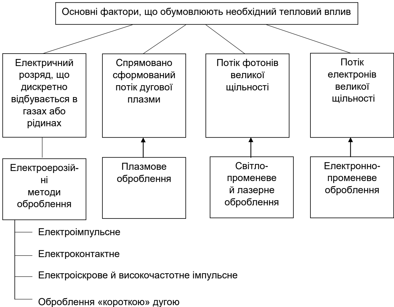
Рисунок 6.3 – Структурна схема методів ЕФХКО, що базується на тепловому впливі електричного струму
