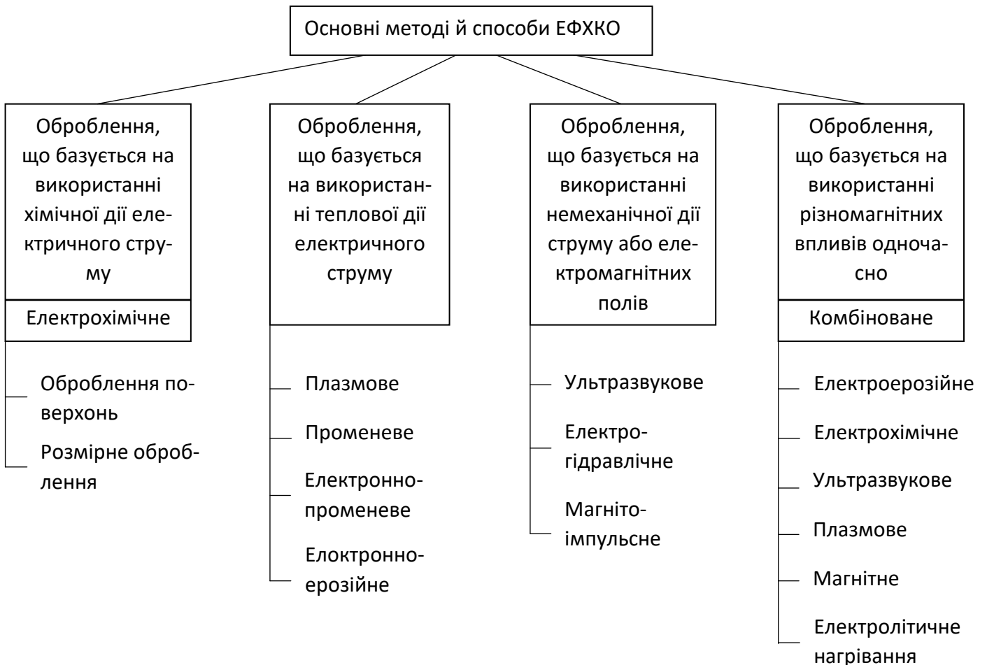
Рисунок 6.1 – Структурна схема методів електротехнології
