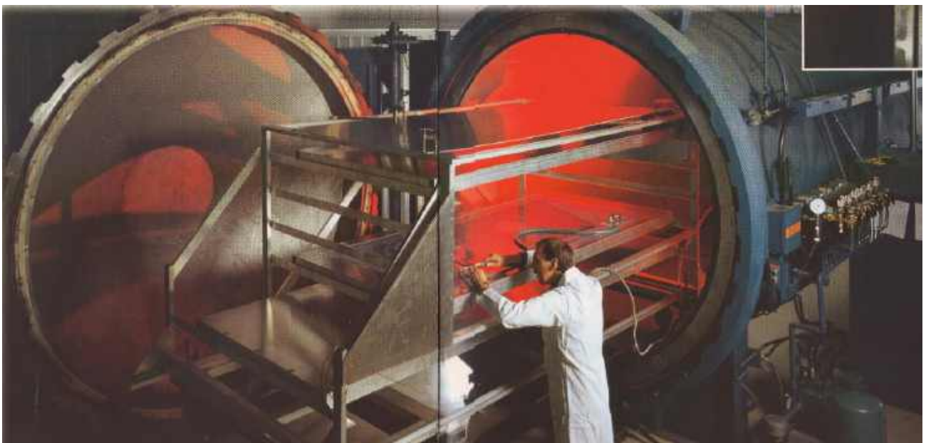
Рисунок 5.6 – Автоклав для виготовлення деталей з композиційних матеріалів
