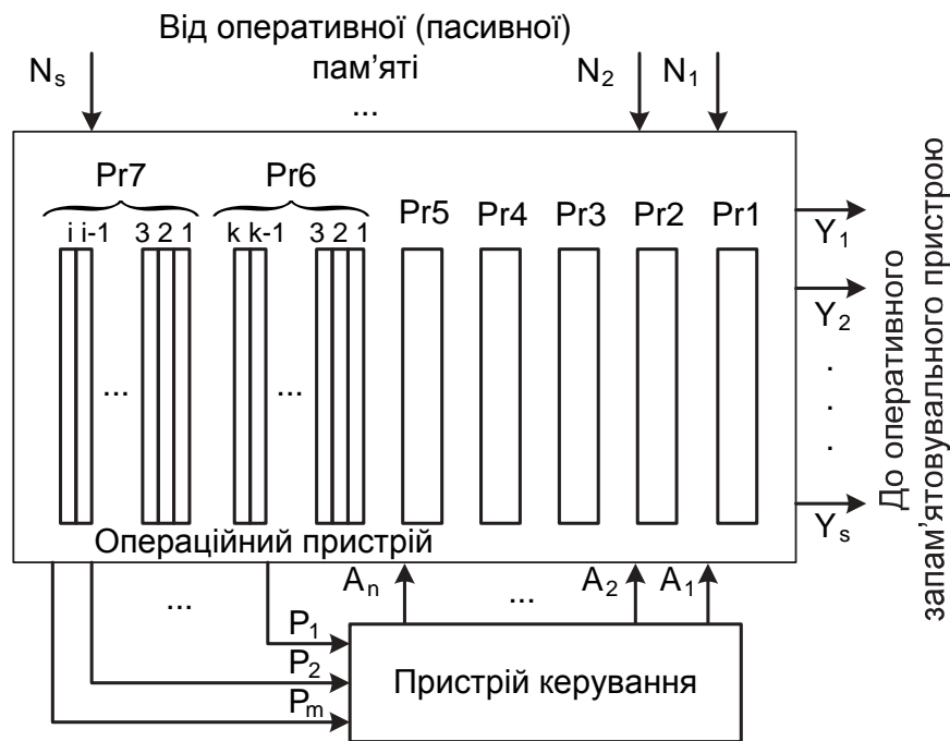
Рис. 2.2. Спрощена структурна схема арифметико-логічного пристрою
