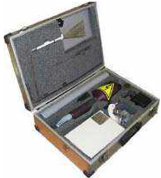
Fig. 12.7. Electric spark defectoscope «Корона-2»
