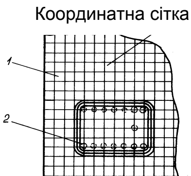
Рисунок 2.8 – Розміщення корпусних мікросхем зі штировими виводами (2) на печатній платі зі стандартною координатною сіткою (1)
