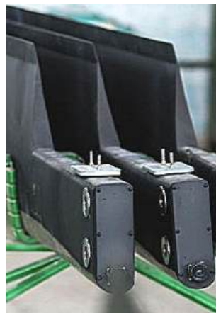
Рис. 14.34. Типова схема та загальний вигляд двоточкового стику композитної лопаті: 1 – шайба; 2 – втулка; 3 – шари із титанової фольги; 4 – пояс лонжерона
