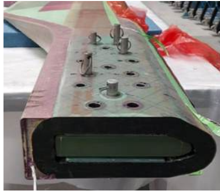
Рис. 14.33. Типова схема (а), загальний вигляд гребінчастого стику лопаті НГ вертольота МСБ-8 (б) та лопаті РГ вертольота СН-53G: 1 – наконечник; 2 – болт; 3 – втулка; 4 – пластина; 5 – пояс лонжерона
