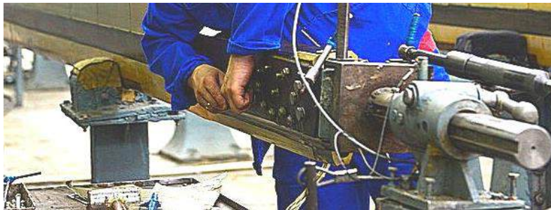
Рис. 14.20. Кондуктор для оброблення отворів у лонжероні та наконечнику
