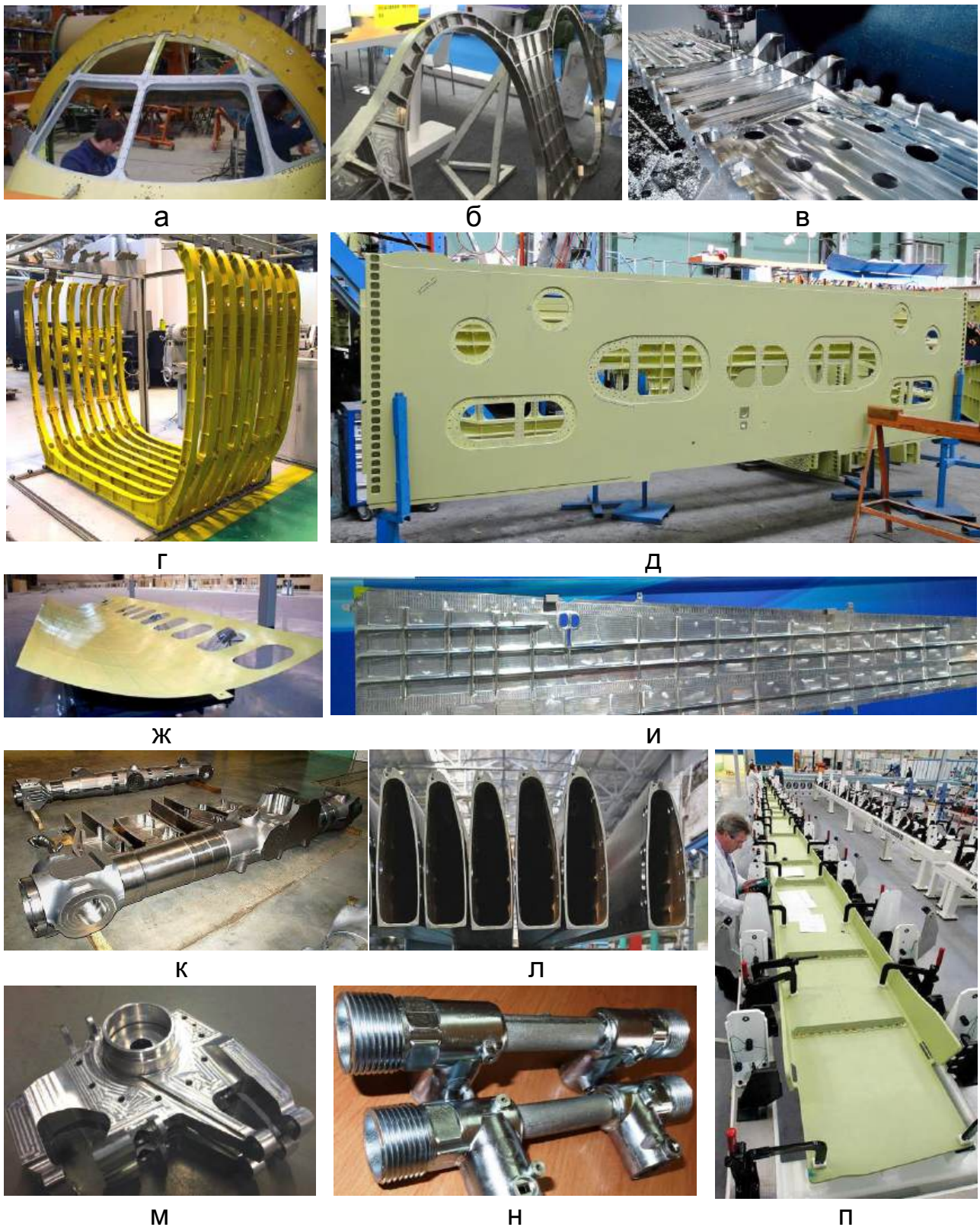
Рис.1.2. Приклади деталей планера ЛА, що оброблюються з видаленням зайвого матеріалу: а – каркас ліхтаря кабіни пасажирського літака; б – монолітний шпангоут винищувача; в – силова нервюра крила; г – збірно-монолітний шпангоут вертольота; д – панель центроплана пасажирського літака; ж – листова обшивка фюзеляжу; и – панель крила; к – носовий стояк шасі пасажирського літака; л – лонжерон лопаті несучого гвинта вертольота; м – кронштейн; н – штуцер; п – лонжерон крила аеробуса
