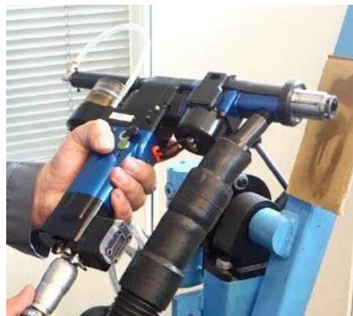
Рис. 11.10. Компонувальна схема (а) та загальний вигляд (б) СМАП моделі ST1200: 1 – вібратор; 2 – маслянка; 3 – регулятор частоти обертання; 4 – патрон із щільною насадкою; 5 – штуцер витяжної вентиляції; 6 – регулятор подачі; 7 – пускова кнопка; 8 – блок пневматичної турбіни; 9 – кнопка аварійної зупинки; 10 – регулятор кількості циклів оброблення; 11 – штуцер пневматичної мережі
