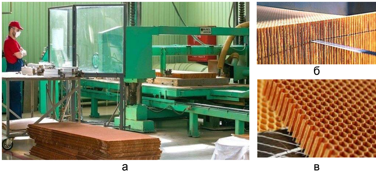
Рис. 13.9. Загальний вигляд стрічкнопильного верстата та розрізаних стільникових блоків з полімерсотопласта
