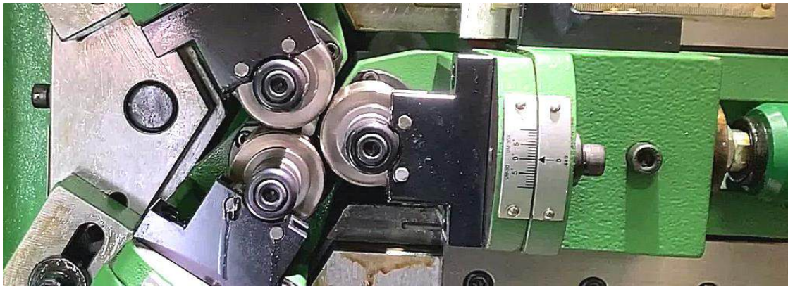
Рис. 10.15. Роликова головка, що вбудована в стаціонарне обладнання
