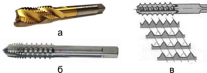
Рис. 10.20. Мітчики з гвинтовими стружковими канавками та з вирізаною ниткою
