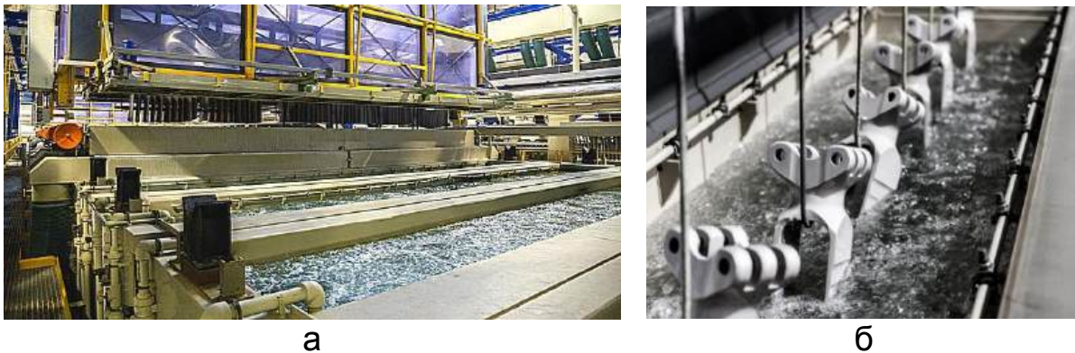
Рис. 14.9. Автоматизована лінія гальванічних ванн
