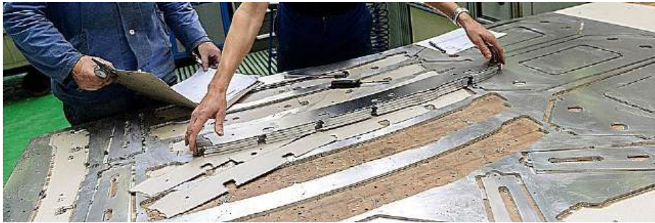
Рис. 12.6. Загальний вигляд листових заготовок після розкроювання
