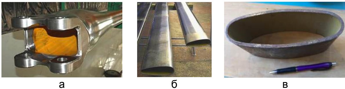
Рис. 14.23. Зовнішній вигляд трубчастого лонжерона після шліфування з боку: а – наконечника; б – консолі; в – зразка-темплета із середньої частини труби
