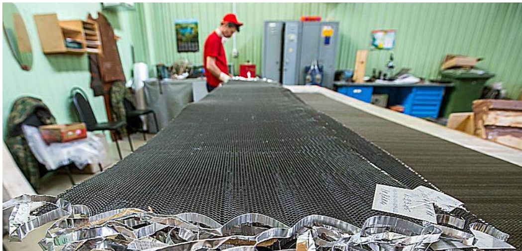
Рис. 13.5. Схема приклеювання тканини до заготовки (а) та загальний вигляд стільникового блока після розтягування пакета (б); 1 – ложемент; 2 – вантаж; 3 – стільниковий пакет; 4 – стрічка
