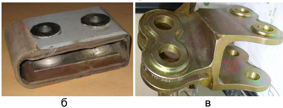
Рис. 14.38. Конструктивна схема (а) та загальний вигляд (б) стикувального вузла лопаті легкого вертольота: 1 – лонжерон; 2 – втулка комлевого стику; 3 – гайка; 4 – втулка розпірна; 5 – шайба; 6 – пластина опорна
