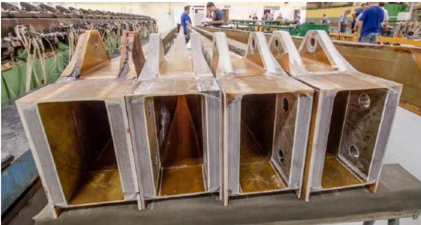
Рис. 14.36. Загальний вигляд композитних лонжеронів лопаті НГ на різних етапах оброблення стикувальних поверхонь
