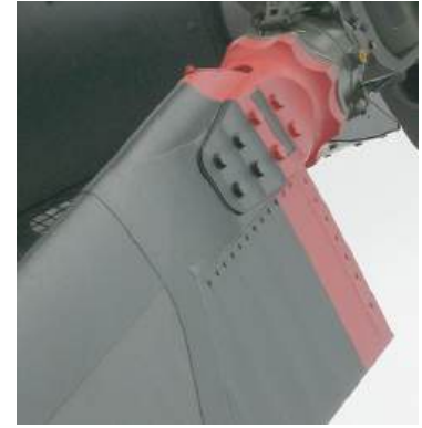
Рис. 14.33. Типова схема (а), загальний вигляд гребінчастого стику лопаті НГ вертольота МСБ-8 (б) та лопаті РГ вертольота СН-53G: 1 – наконечник; 2 – болт; 3 – втулка; 4 – пластина; 5 – пояс лонжерона
