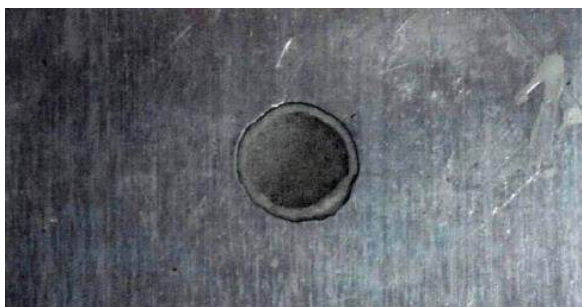
Рисунок 3 – Зовнішній вигляд штучного корозійного дефекту
