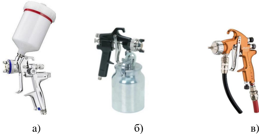
Рисунок 4.8 – Види фарбувальних пістолетів за способом подачі ЛКМ
