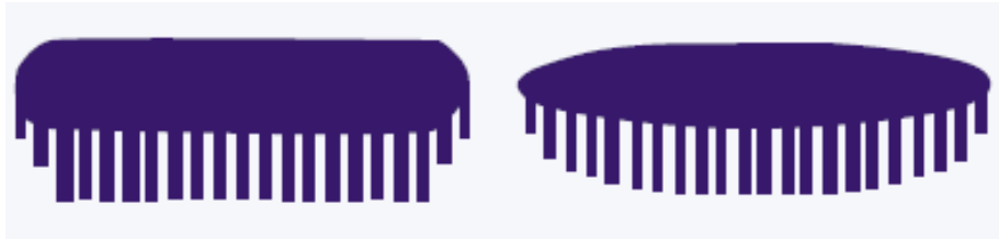
Рисунок 4.9 – Правильна форма відбитка факела на досліджуваній поверхні
