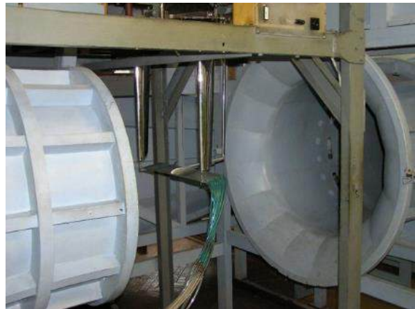
Рис. 3. Навчальна дозвукова аеродинамічна труба Т-5
