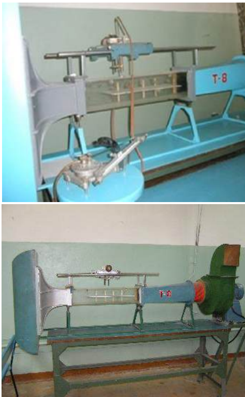
Рис. 2. Навчальна аеродинамічна труба Т-8 для визначення параметрів пограничного шару
