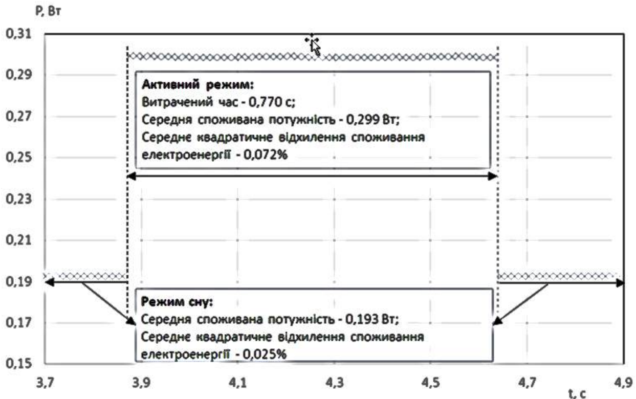
Рис. 1. Первинні експериментальні результати: вимірювання потужності для частоти 300 МГц, напруги 3,3 В
