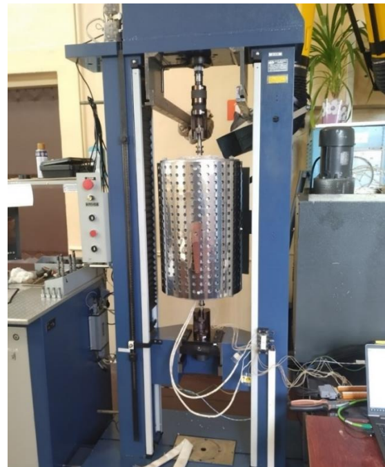
Рис. 4. Випробувальна машина РМ-100 для досліджень на розтяг-стиск з встановленою пічкою
