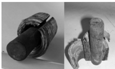
Рис. 2. Вид на торець електрода і його препарований переріз уздовж осі струмопровідного стрижня. Стан ізоляції після 220...250 розрядів на робочих режимах штампування кузовної деталі виділення енергії. Після 300...500 розрядів із виділенням 20 кДж енергії на одній
