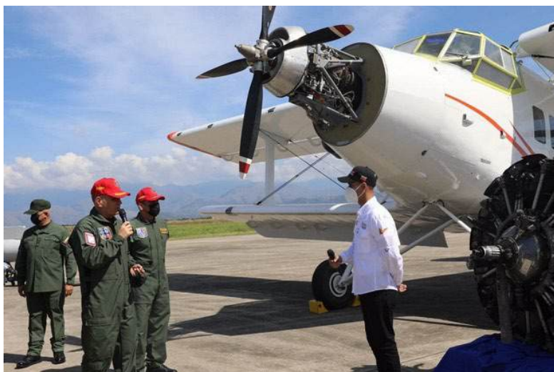
Рис. 7. Літак Ан-2 із встановленим газотурбінним двигуном
