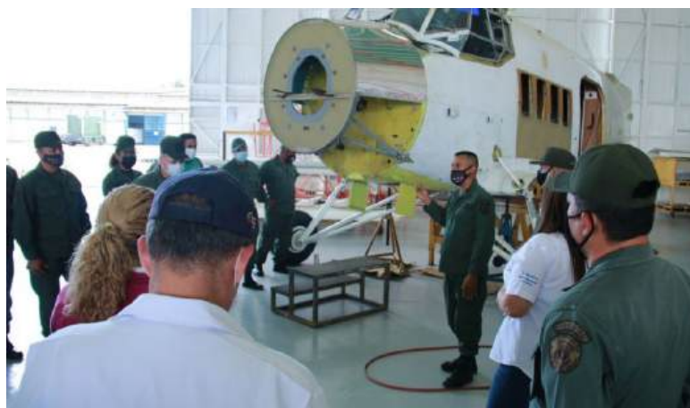
Рис. 8. Літак Ан-2 із встановленим під час ремонту газотурбінним двигуном
