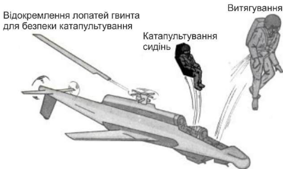
Рис. 7. Схема витягування/катапультивання сидінь
