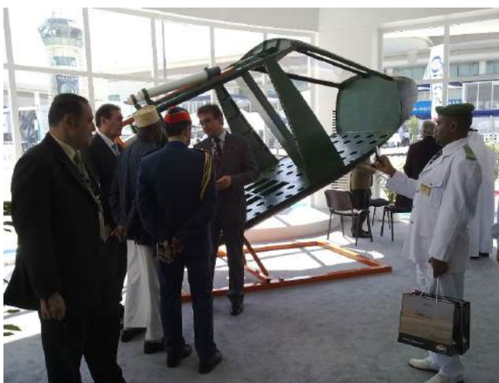
Рис. 23. Рятувальна капсула вертольота AVQ із встановленими зверху прискорювачами на Dubai Air Show 2011
