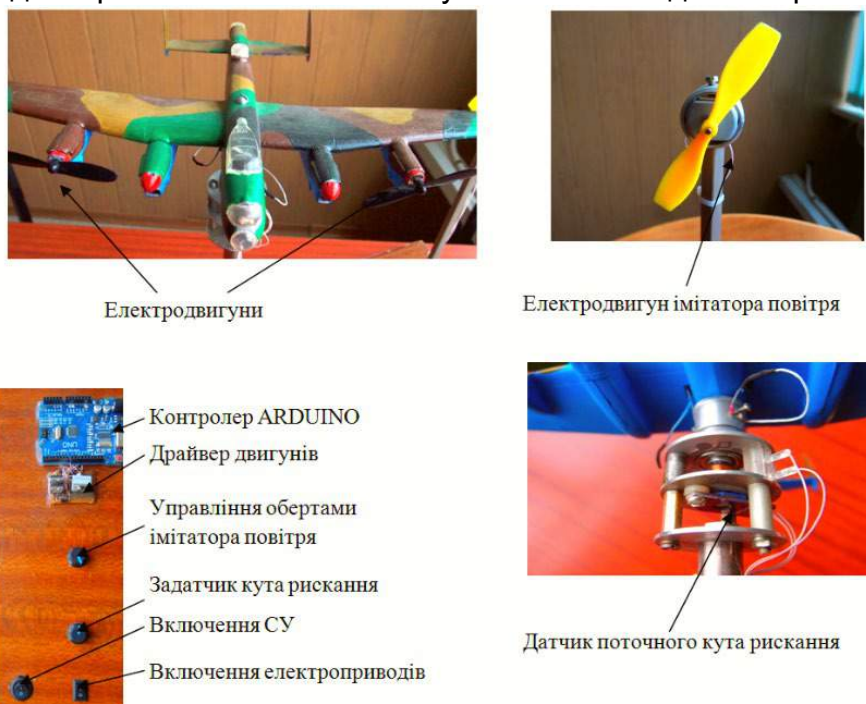
Рис. 5. Склад та призначення елементів експериментальної установки
