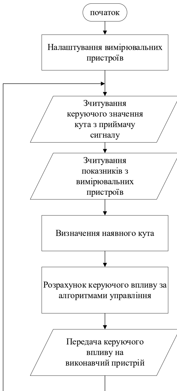
Рис. 6. Алгоритм роботи контролера
