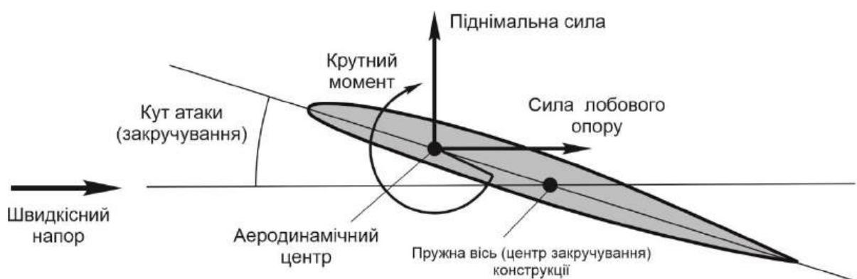
Рис. 1. Схема взаємодії аеродинамічних і пружних сил
