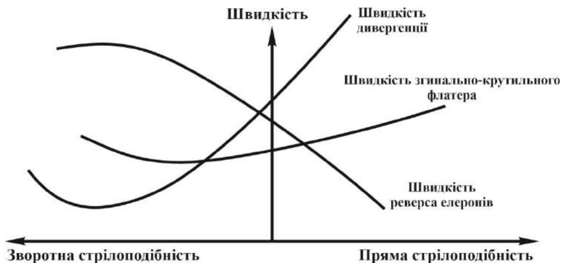
Рис. 2. Характер впливу стрілоподібності крила на критичні швидкості
