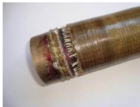
Рис. 18. Вирир шипів фланцевого з'єднання
