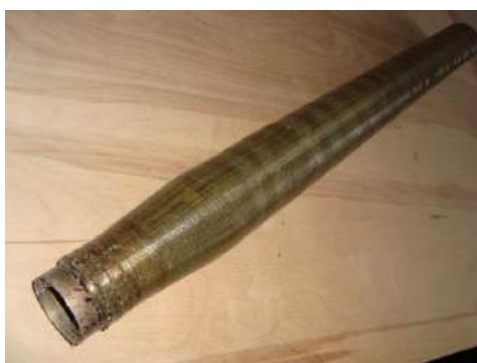
Рис. 17. З'єднання метал-композит після випробувань
