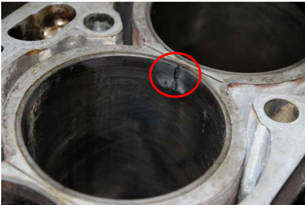
Рисунок 1.11 – Тріщина на поверхні гільзи [18]
