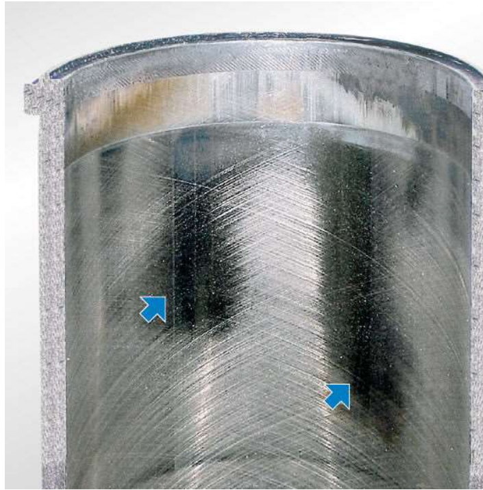
Рисунок 1.5 – Абразивне зношування на робочій поверхні циліндра [18]
