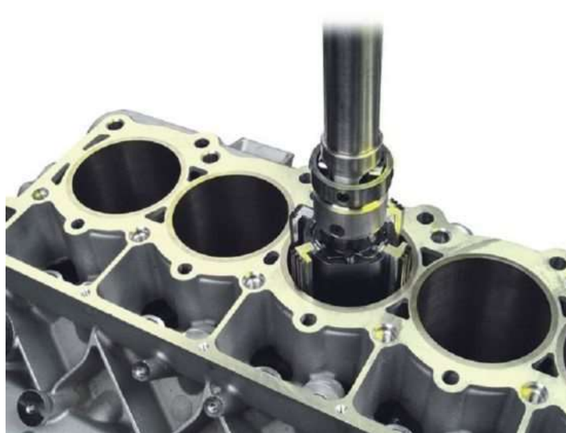
Рисунок 1.15 – Процес хонінгування гільзи циліндра [17]
