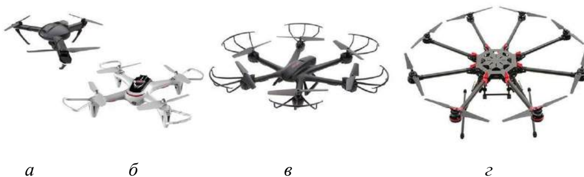
Рисунок 1.3 – Трикоптер (а), quadroкоптер (б), гексакоптер (в) та октокоптер (z)
