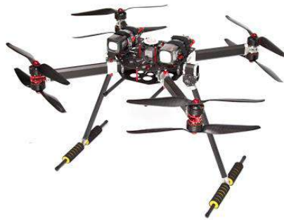
Рисунок 1.9 – Квадрокоптер, побудований за коаксіальною схемою
