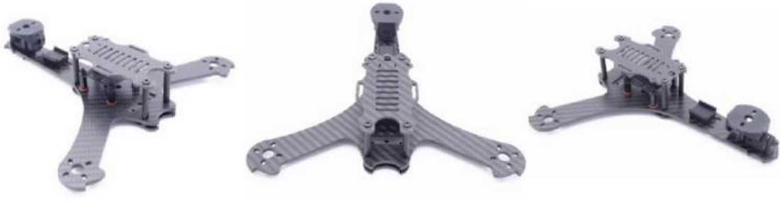
Рисунок 5.1 – Рама майбутнього трикоптера
