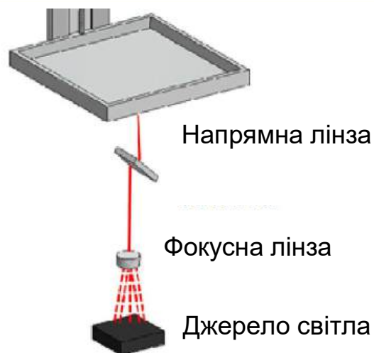
Рисунок 5 – Механізм друкування методом SLA
