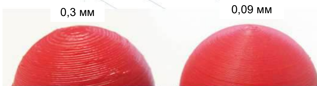
Рисунок 19 – Якість поверхні шару залежно від товщини шару друкування
