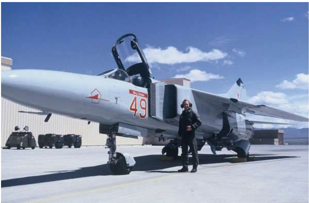
Рис. 6.10. Літак-випищувач МіГ-23 (крило на максимальній стрілоподібності)
