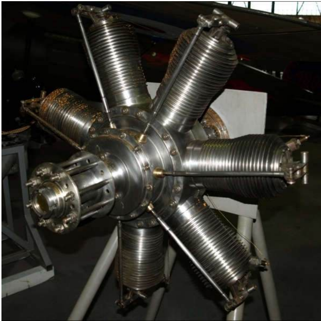
Рис. 1.17. Ротативний двигун повітряного охолодження «Гном»
