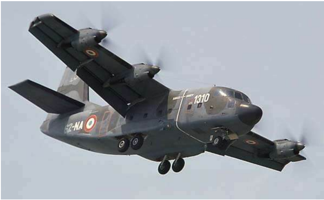
Рис. 5.3. Транспортний літак з укороченим зльотом і посадкою «Бреге-941» (Франція, 1958)
