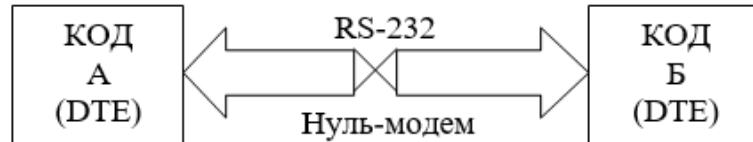
Рисунок 3.3 – Скорочена схема з'єднання з допомогою інтерфейсу RS-232C
