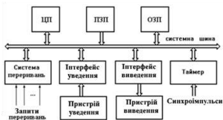
Рисунок 13.1 – Структурна схема мікропроцесорної системи
