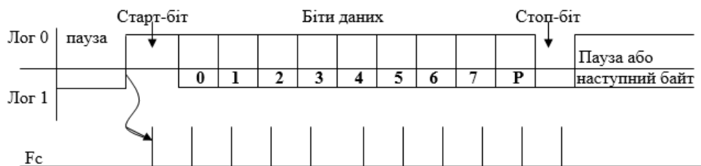
Рисунок 3.1 – Структура послідовного передавання даних
