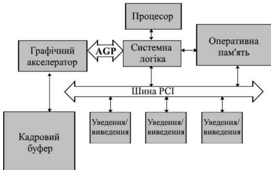
Рисунок 6.4 – Системна архітектура порту PCI
