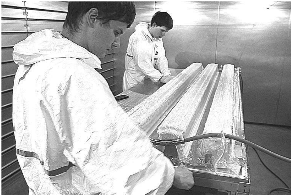
Рисунок 2.10 – Упакування виклейної форми у вакуумний мішок
