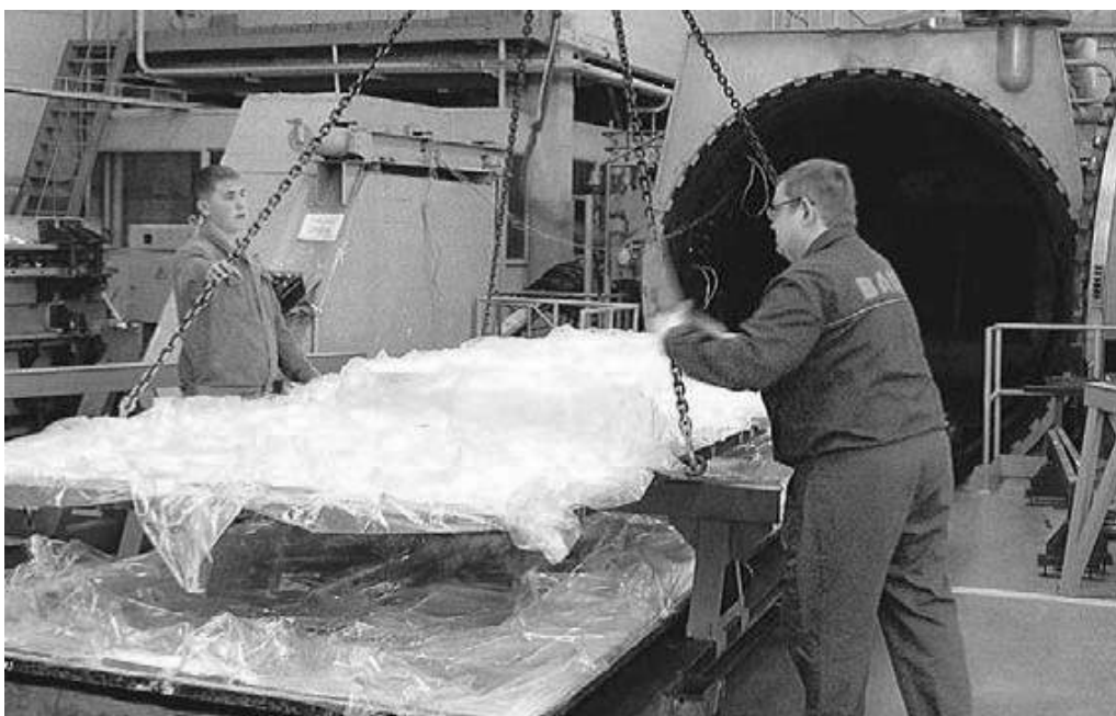
Рисунок 2.11 – Завантаження в автоклав виклейних форм
