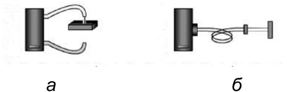
Рис. 4.11. Волоконно-оптичний датчик положення: а – перетинання світлового потоку; б – відображення світлового потоку
