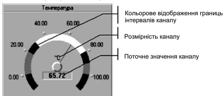
Рис. 8.1. Приклад графічного динамічного елемента типу «стрілковий прилад»
