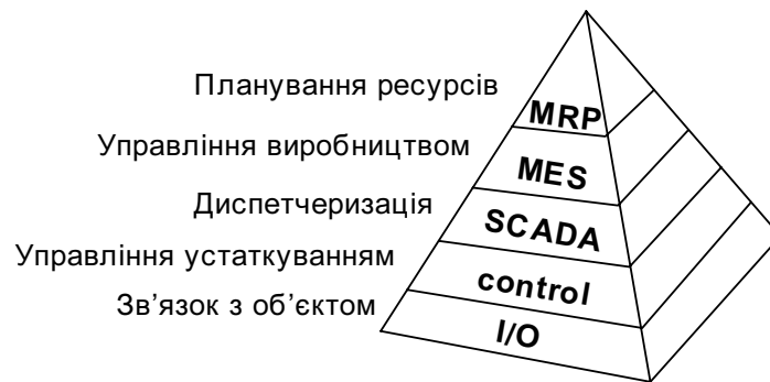
Рис. 2.1. Рівні автоматизації сучасного виробництва
