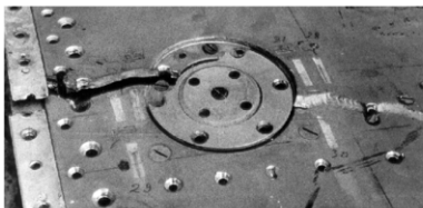
Втомні тріщини в обшивках і панелях
