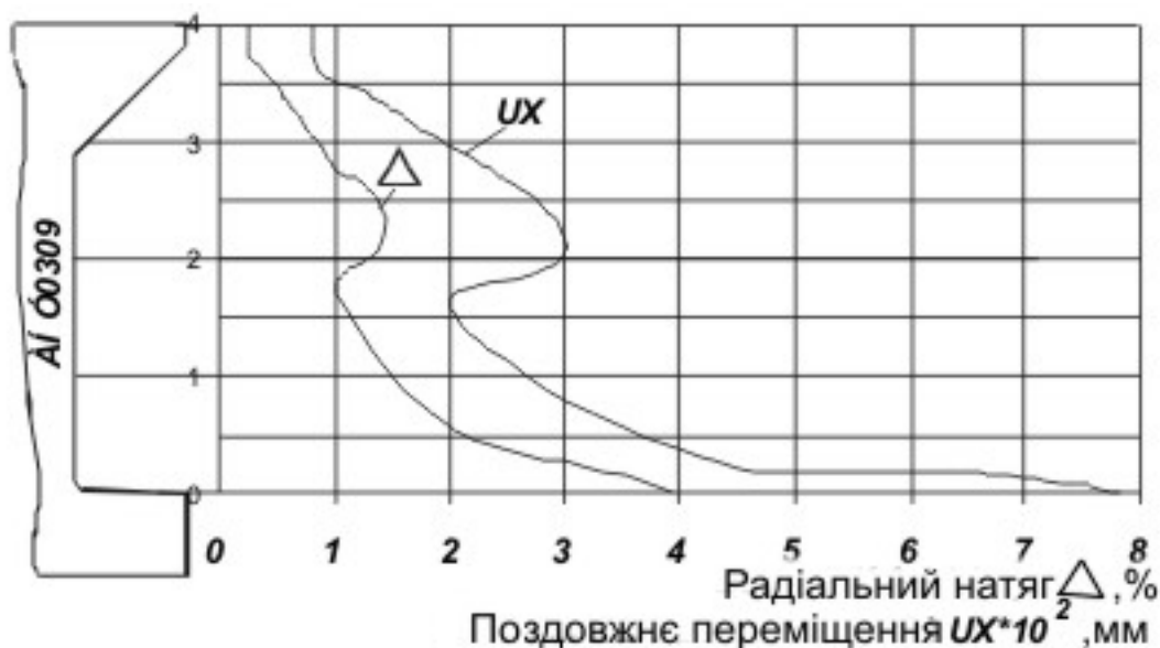
Рис. 2.72. Характер розподілу радіального натягу по товщині пакета
