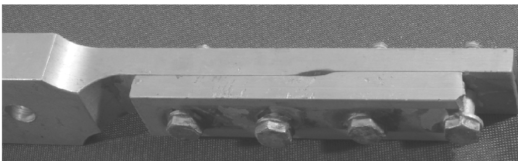
Рис. 8.8. Зразок двоступінчатого зрізного з'єднання з полімерним заповнювачем між поверхнями, що сполучаються
