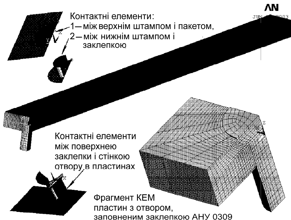
Рис. 2.62. Скінченноелементна модель заклепочного з'єднання
