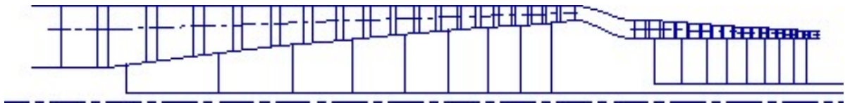
Рисунок 2.8 - Схема проточної частини компресора
