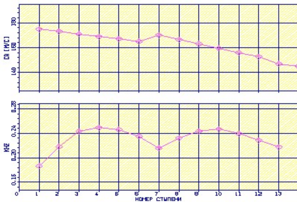
Рисунок 2.5 - Графік зміни Ca і \overline{\eta}_z по ступеням компресора
