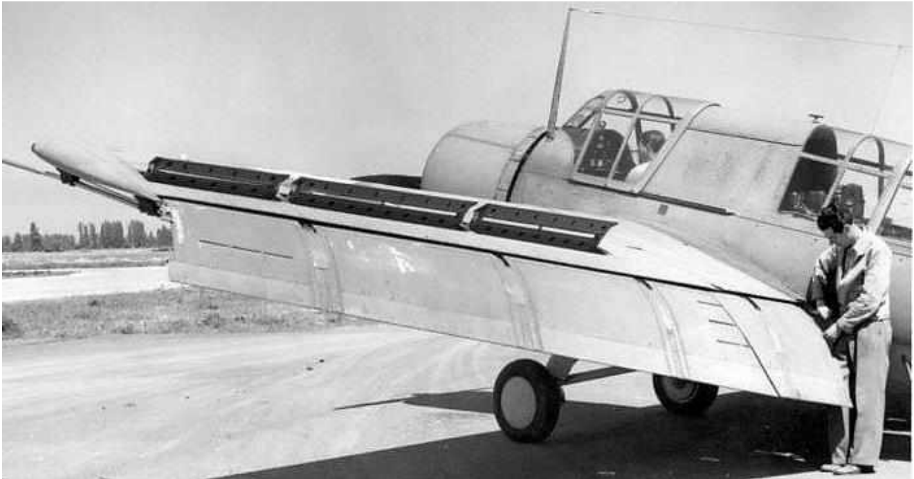
Рисунок 77 – Висувний щиток (Zap Flap) літака Vought OS2U «Kingfisher» у випущеному стані [86]
