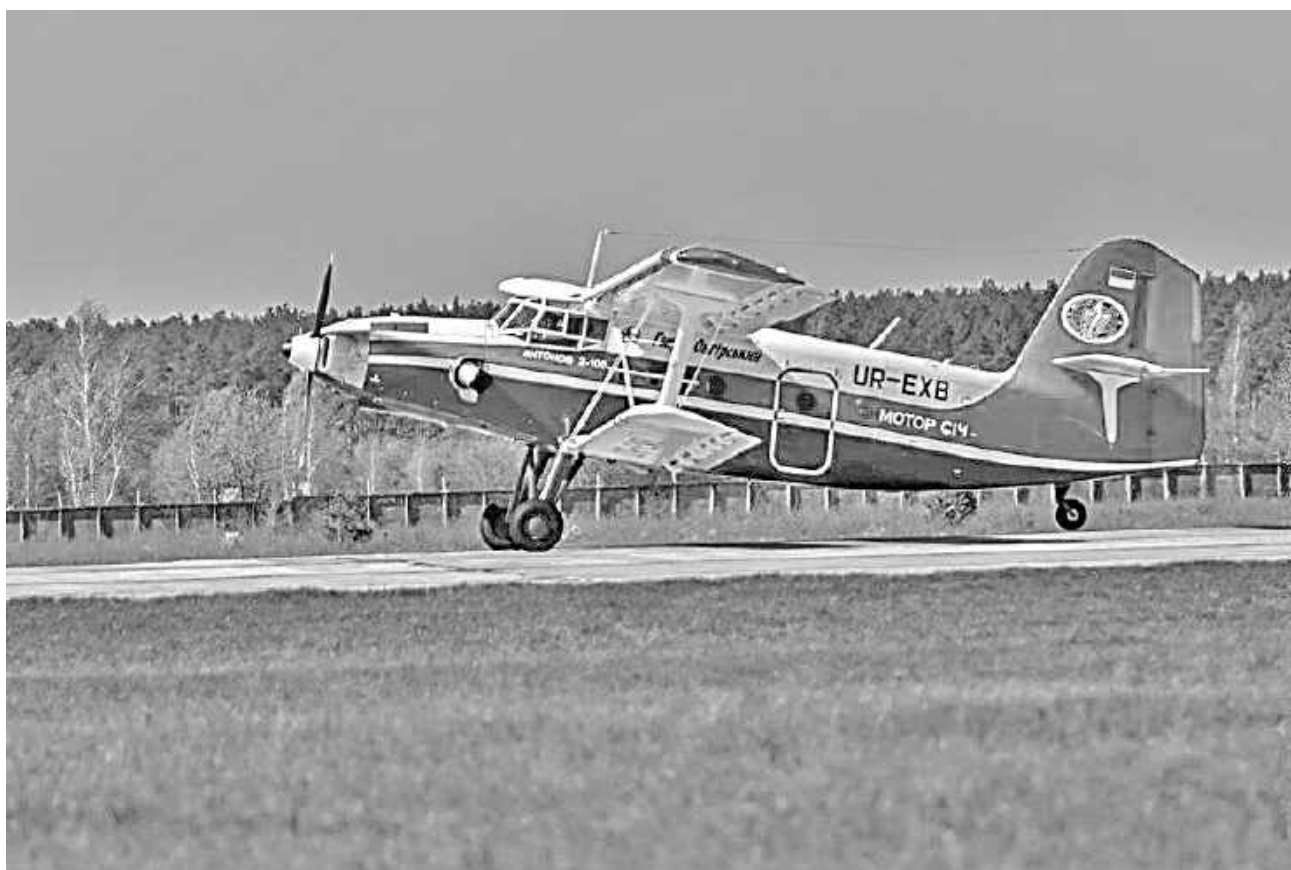
Рисунок 61 – Модернізований на ПАТ «Мотор Січ» літак Ан-2 з автоматичним передкрилком на верхньому крилі [72]
