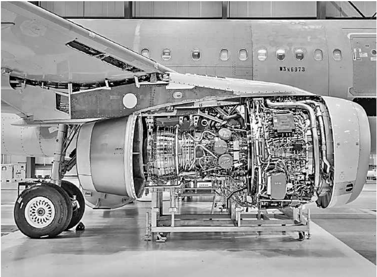
Рисунок 23 – Кріплення двигуна IAE V2500 до пілона літака Airbus A321 [30]
