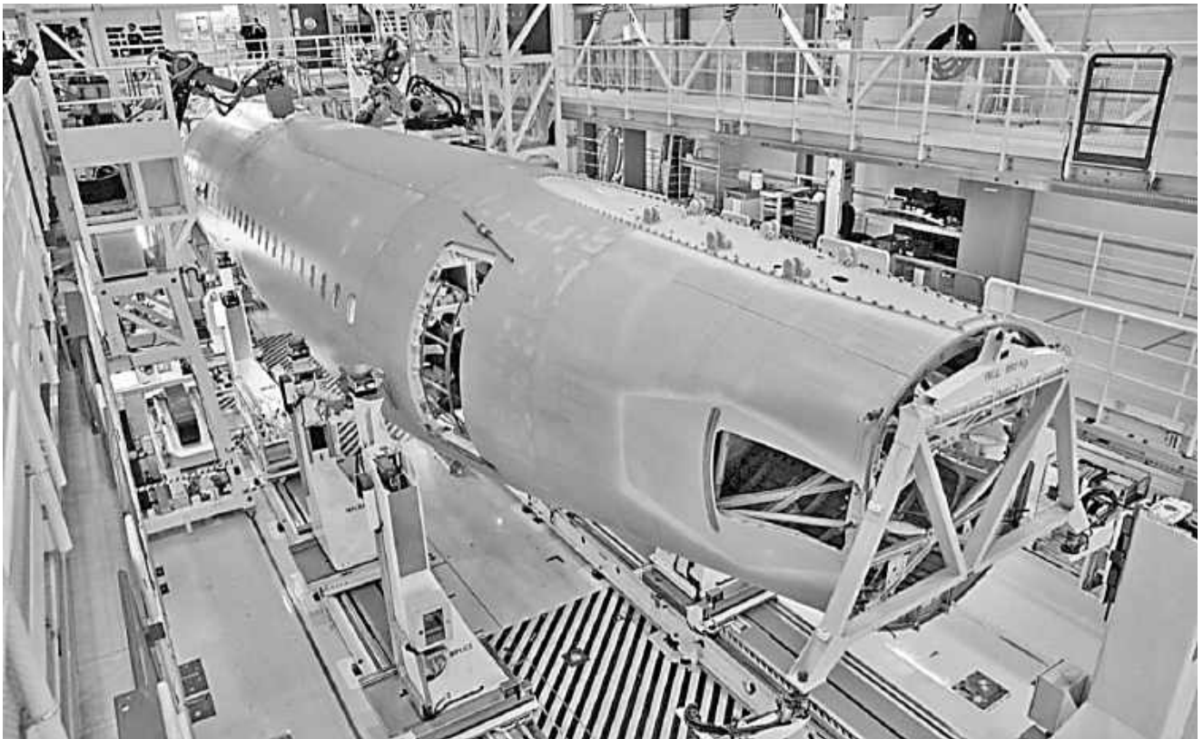
Рисунок 175 – Фюзеляж літака Airbus A320 з вирізом у хвостовій частині під переставне горизонтальне оперення [173]
