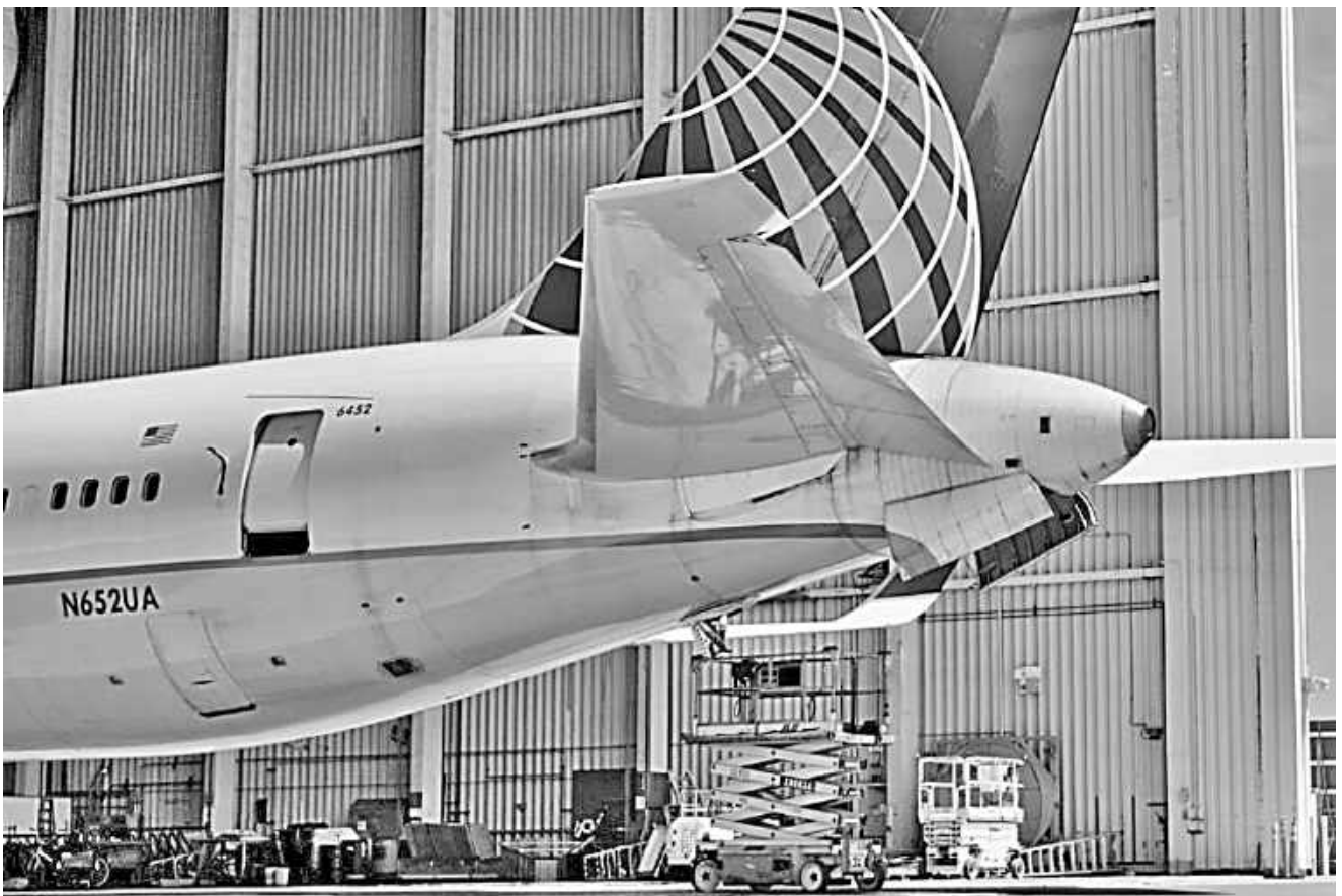
Рисунок 49 – Відкриті ступки й вихлопний пристрій ДСУ в хвостовій частині літака Boeing 767 [60]
