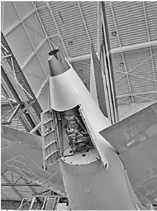
Рисунок 44 – Відсік ДСУ й вихлопний пристрій у хвостовій частині літака Airbus A380 [53, 54]
