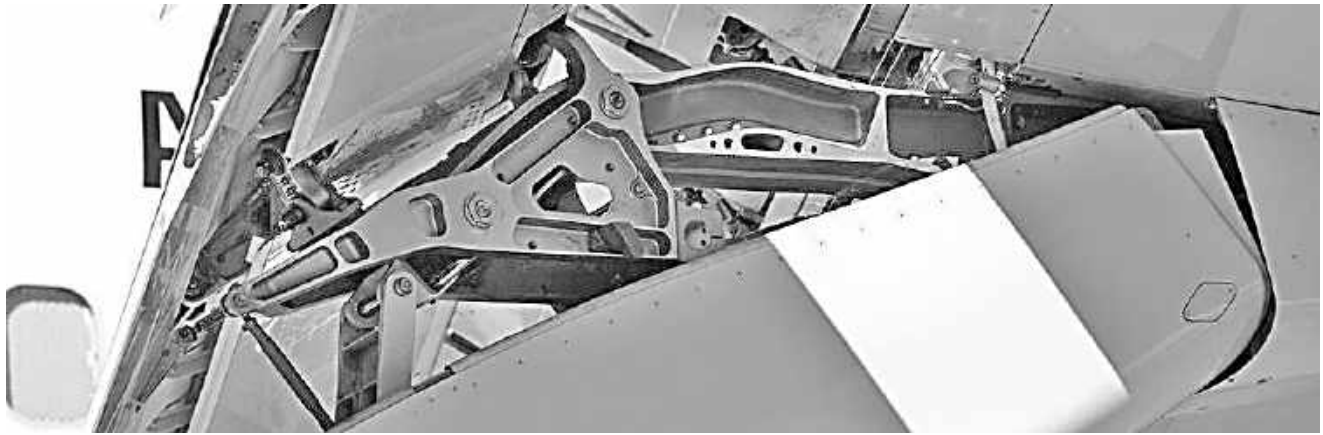
Рисунок 81 – Висувний закрилок з закріпленою на ньому кареткою для переміщення по опорному пристрою на крилі літака Boeing 737 [88]
