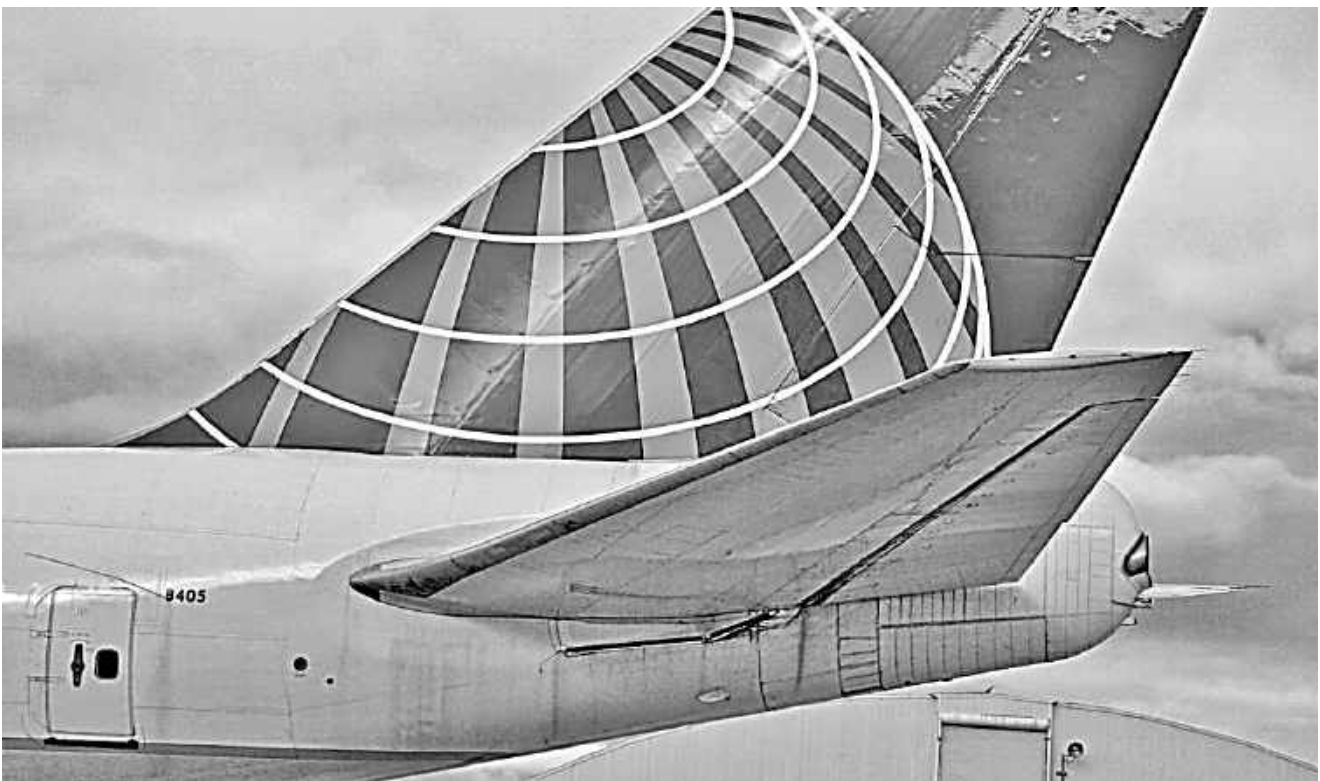
Рисунок 47 – Закриті стулки й вихлопний пристрій ДСУ в хвостовій частині [58] літака Boeing 747
