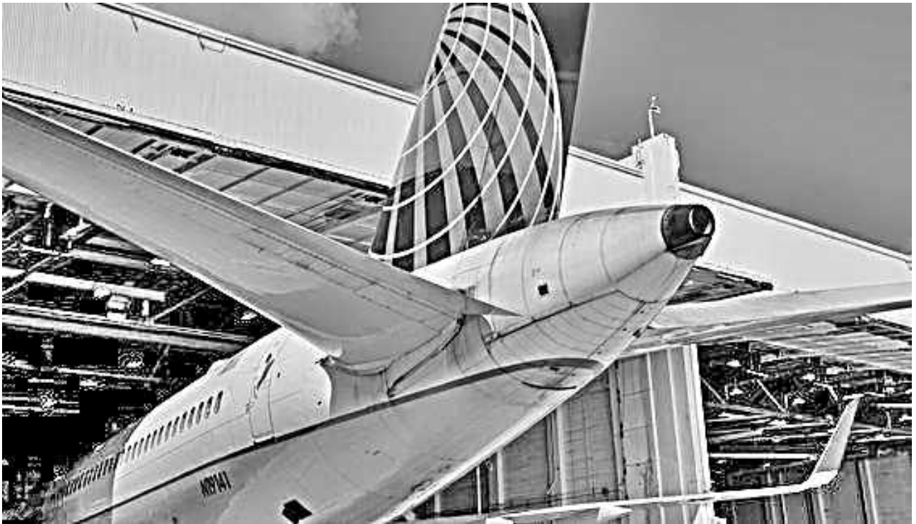
Рисунок 48 – Закриті ступки відсіку ДСУ й вихлопний пристрій літака Boeing 757 [59]
