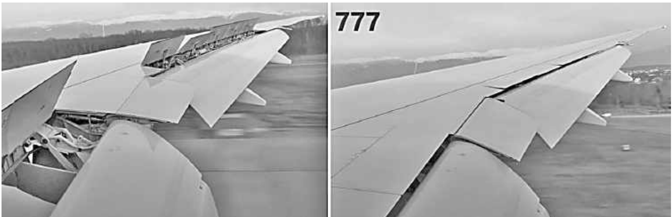
Рисунок 86 – Права консоль крила літака Boeing 777 з внутрішніми й зовнішніми закрилками різних схем і з випущеними (на фото зліва) спойлерами під час приземлення
