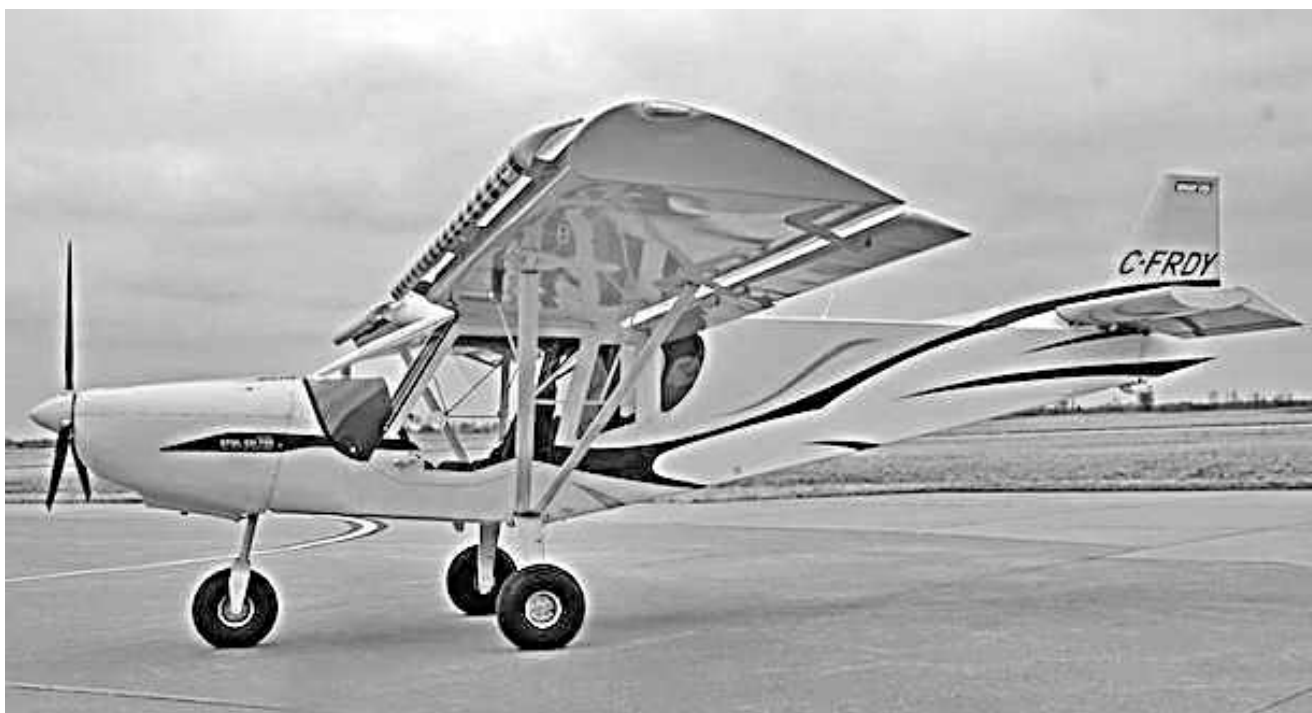
Рисунок 60 – Фіксований передкрилок на передній кромці крила літака [71]
