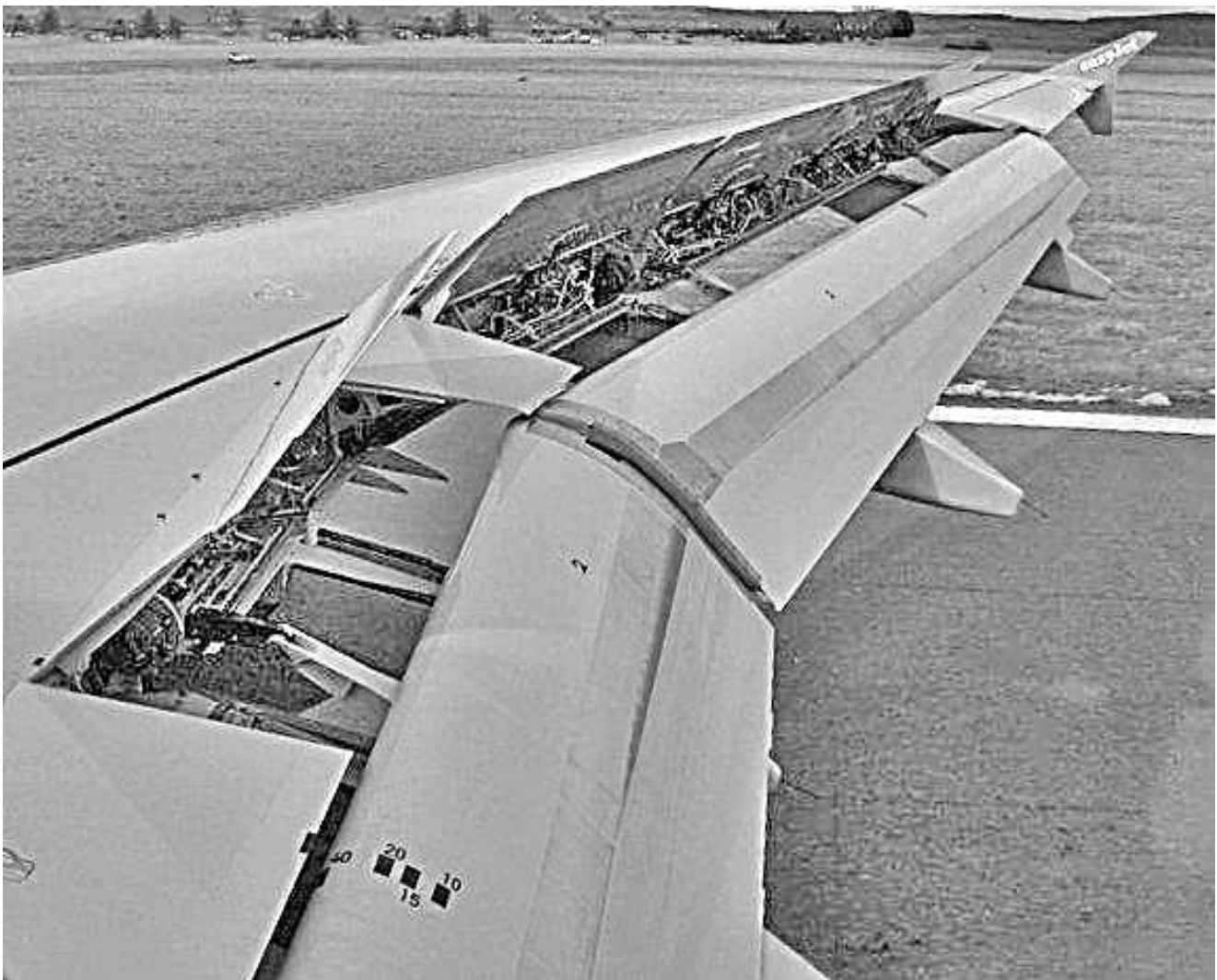
Рисунок 85 – Висувні однощільні закрилки літака Airbus A319 з піднятими спойлерами під час його пробігу [91]
