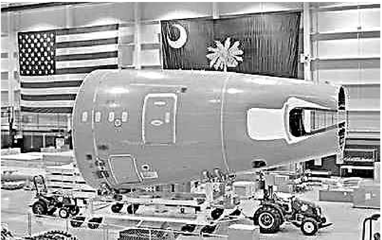
Рисунок 176 – Виріз у фюзеляжі літака Boeing 787 під переставне горизонтальне оперення [174]
