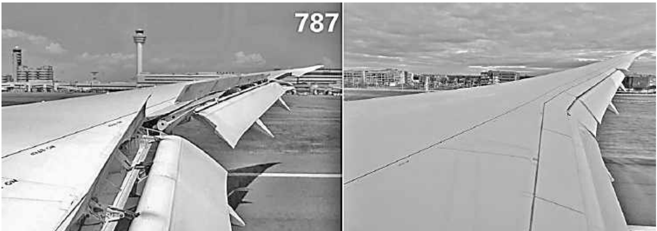
Рисунок 84 – Висувні однощільні закрилки літака Boeing 787 з випущеними й прибраними спойлерами
