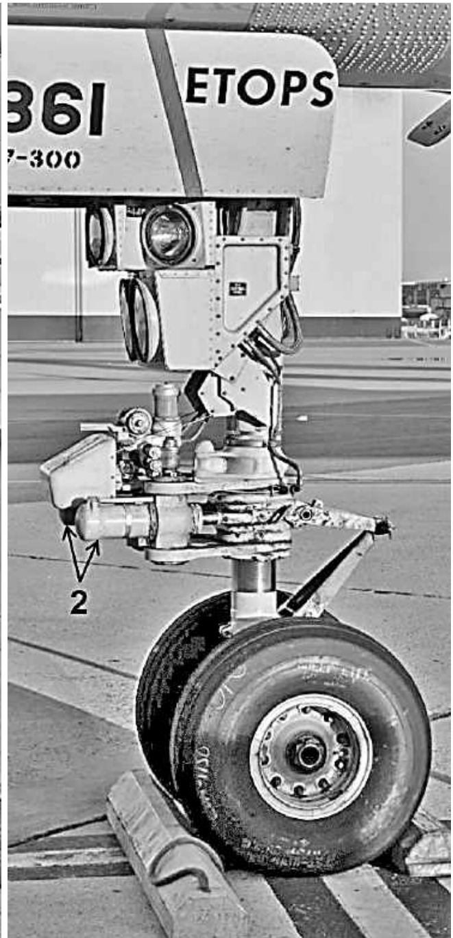
Рисунок 138 – Гідроциліндри демпфера шимі та керування поворотом коліс носового стояка: 1 – літака А320; 2 – літака Boeing 757 [147, 148]
