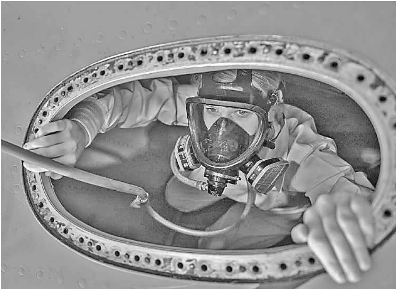
Рисунок 112 – Люк-лаз на верхній поверхні крила літака Boeing C-17 Globemaster III [118, 119]
