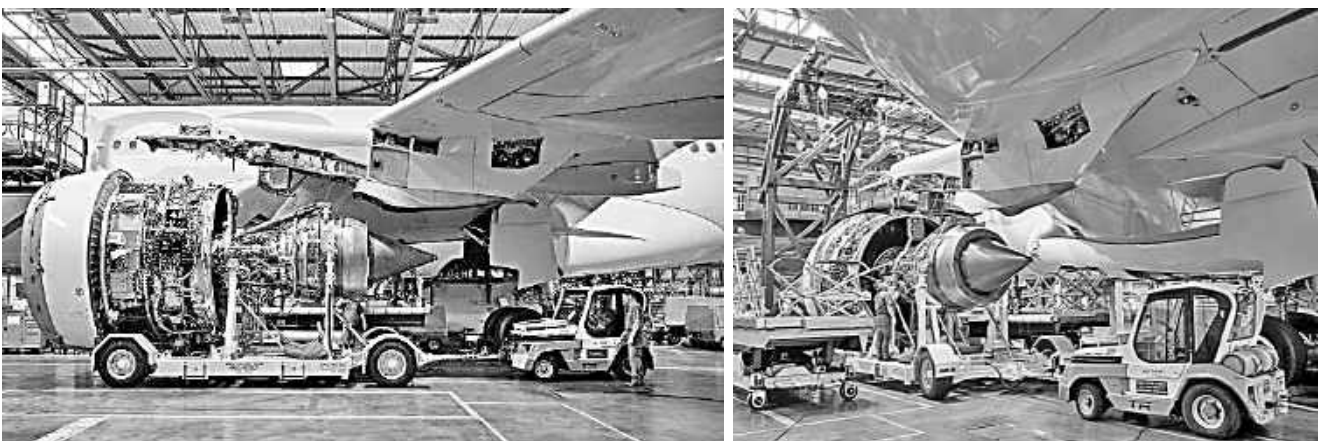
Рисунок 32 – Установлення двигуна Rolls Royce Trent 7000 [41, 42] на пілон літака Airbus A330neo
