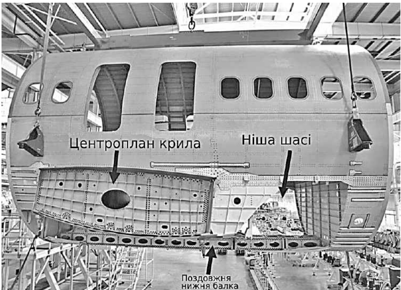
Рисунок 159 – Конструкція фюзеляжу в зоні вирізів під аварійні виходи, центроплан і нішу шасі сімейства китайських вузькофюзеляжних середньомісних пасажирських літаків С919 [156]
