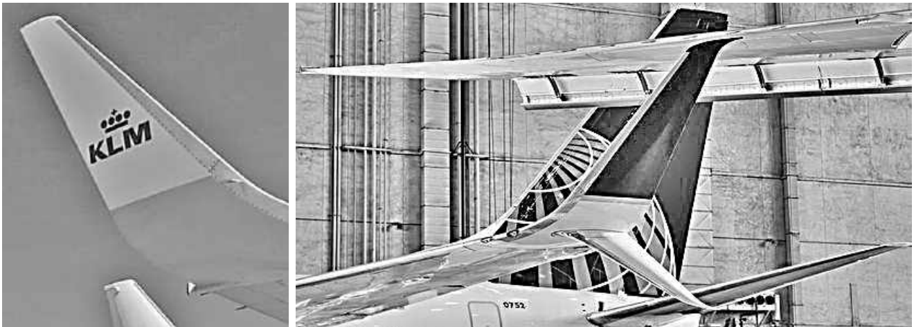
Рисунок 105 – Закінцівки крил типу «Blended Winglet» і «Split Scimitar Winglet» літаків Boeing 737 [108, 109]
