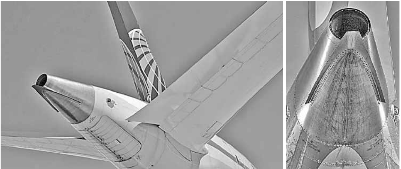
Рисунок 52 – Закриті стулки й вихлопний пристрій ДСУ в хвостовій частині літака Boeing 787 [63, 64]
