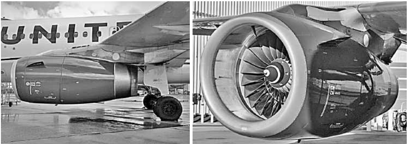
Рисунок 25 – Гондоли з двигунами на пілонах літака Airbus A319
