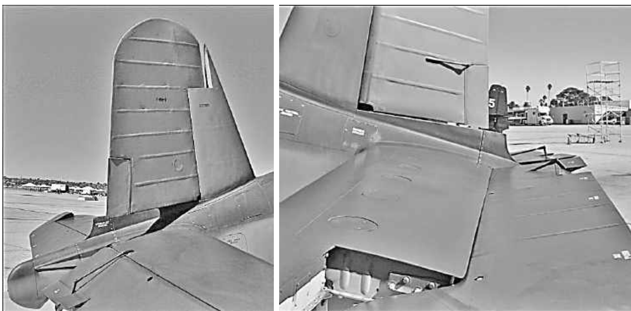
Рисунок 125 – Сервокомпенсатори руля напрямку й руля висоти літака Vought F4U Corsair [133]
