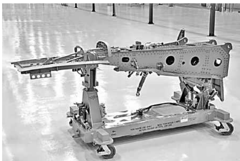
Рисунок 15 – Схема під'єднання та зовнішній вигляд пілона, який використовується для літаків Bombardier [20, 21]
