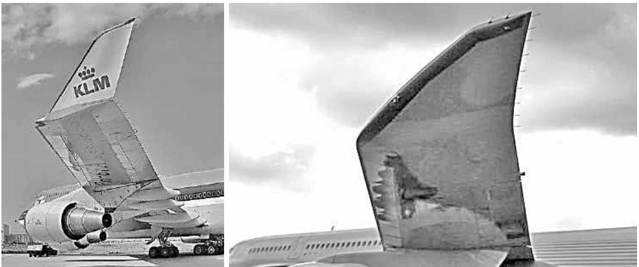
Рисунок 107 – Закінцівки крил типу «Classic Winglet» літака Boeing 747-400(M) і типу «Raked Wingtip» літака Boeing 747-8i [112, 113]
