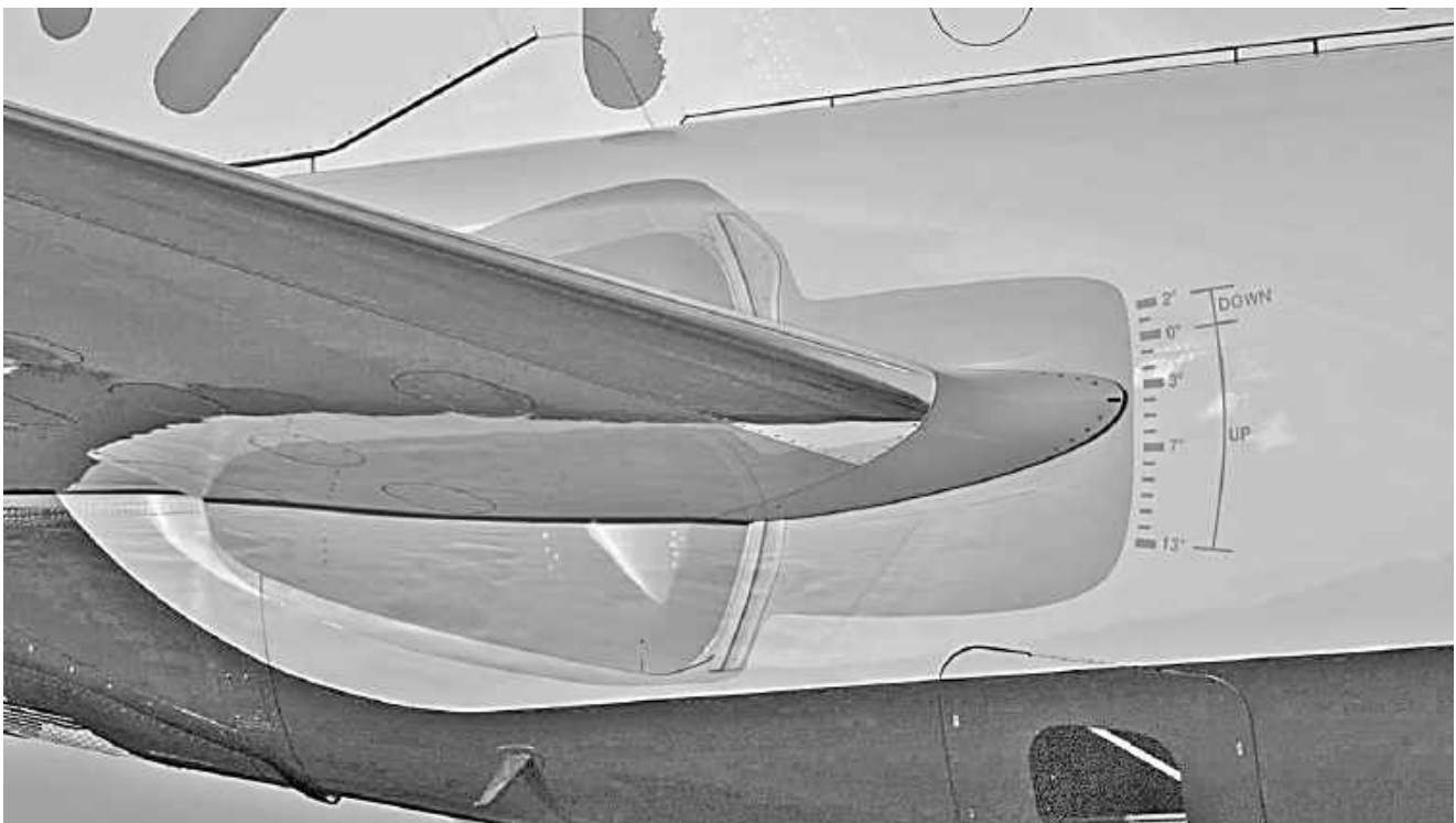
Рисунок 180 – Виріз під переставне горизонтальне оперення у фюзеляжі літака Embraer E170, закритий спеціальними накладками [178]
