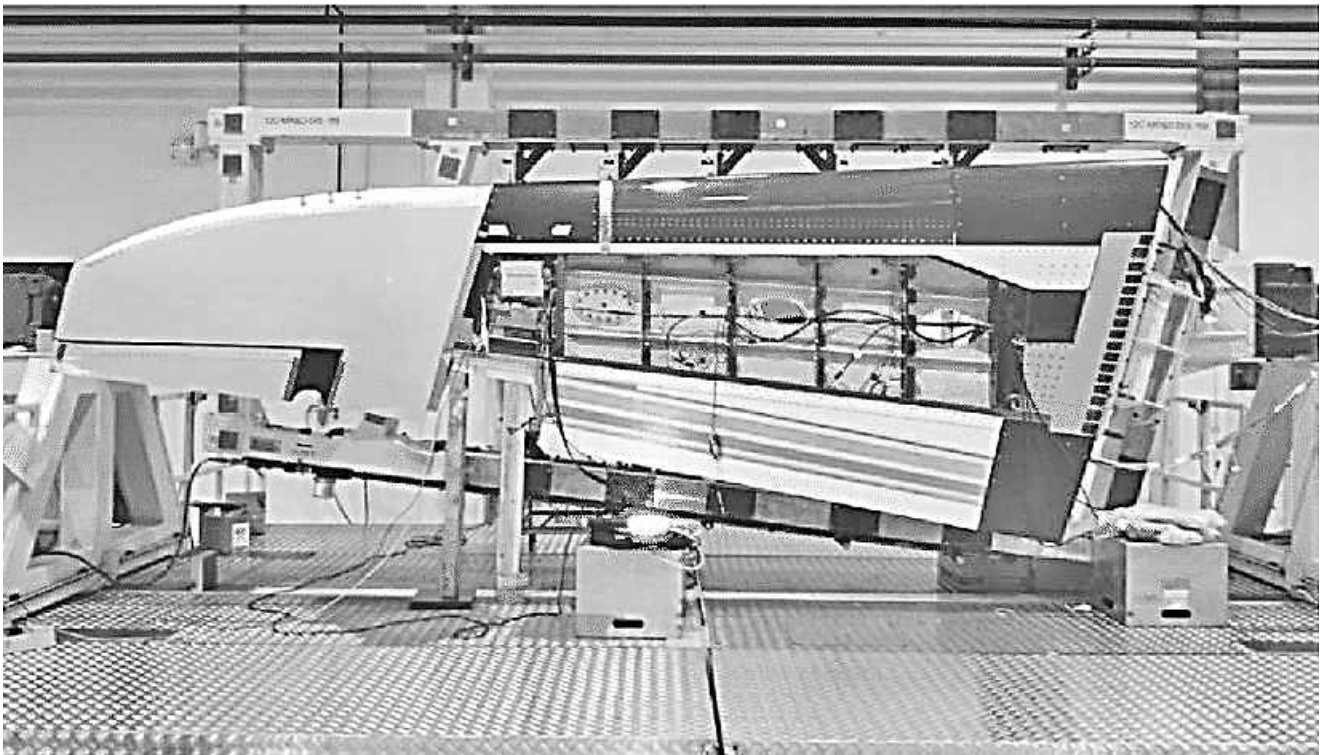
Рисунок 97 – Експериментальне морфінг-крило SARISTU, що складається з різних морфінг-пристроїв (morfining – трансформація, плавне зміння форми) [90]
