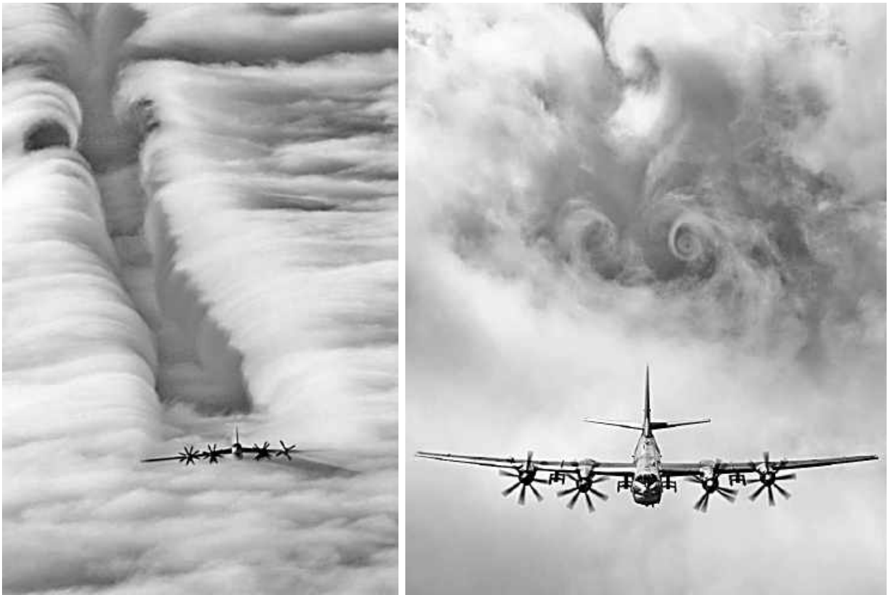
Рисунок 102 – Супутній струмінь (слід), що утворюється після прольоту літака Ту-95 [102, 103]
