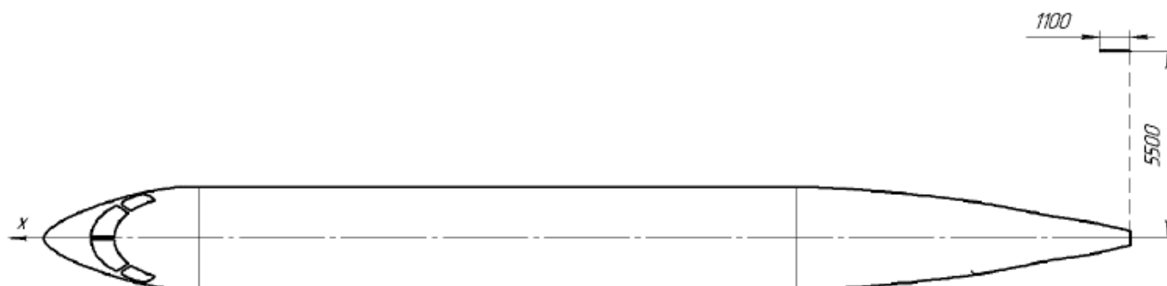
Рисунок 145 – Положення САХ горизонтального оперення на вигляді «у плані»
