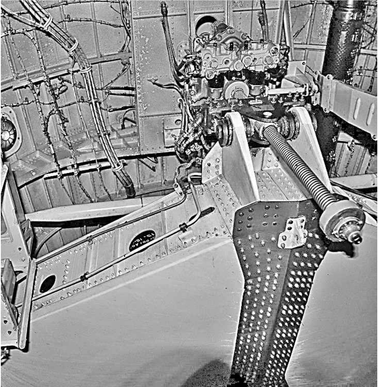
Рисунок 171 – Гвинтовий підйомник (домкрат), під'єднаний до переднього вузла навішування переставного горизонтального оперення літака Airbus A320 для регулювання кута його нахилу під час експлуатації
