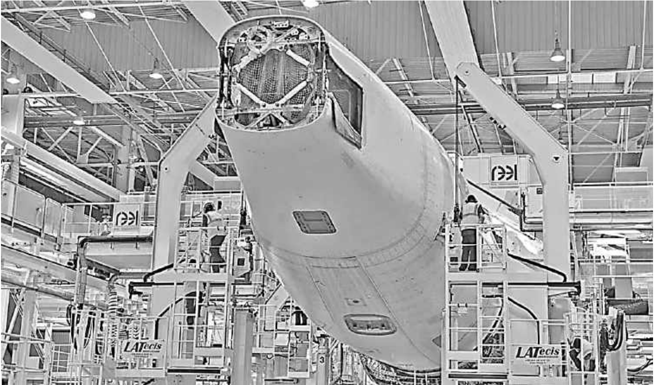
Рисунок 177 – Фюзеляж літака Airbus A350 з вирізом у хвостовій частині під переставне горизонтальне оперення [175]
