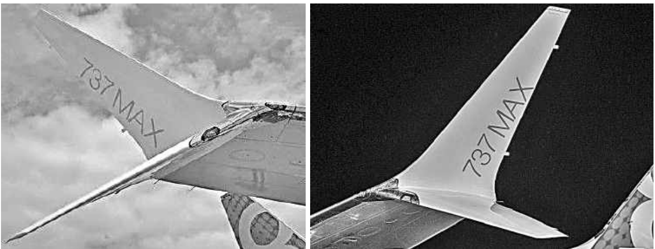
Рисунок 106 – Закінцівки крила типу «Advanced Technology Winglet» літака Boeing 737 MAX 8 [110, 111]
