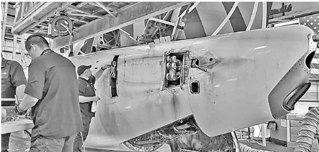
Рисунок 167 – Заміна втулок кріплення горизонтального стабілізатора літака Boeing 737-700 [164]
