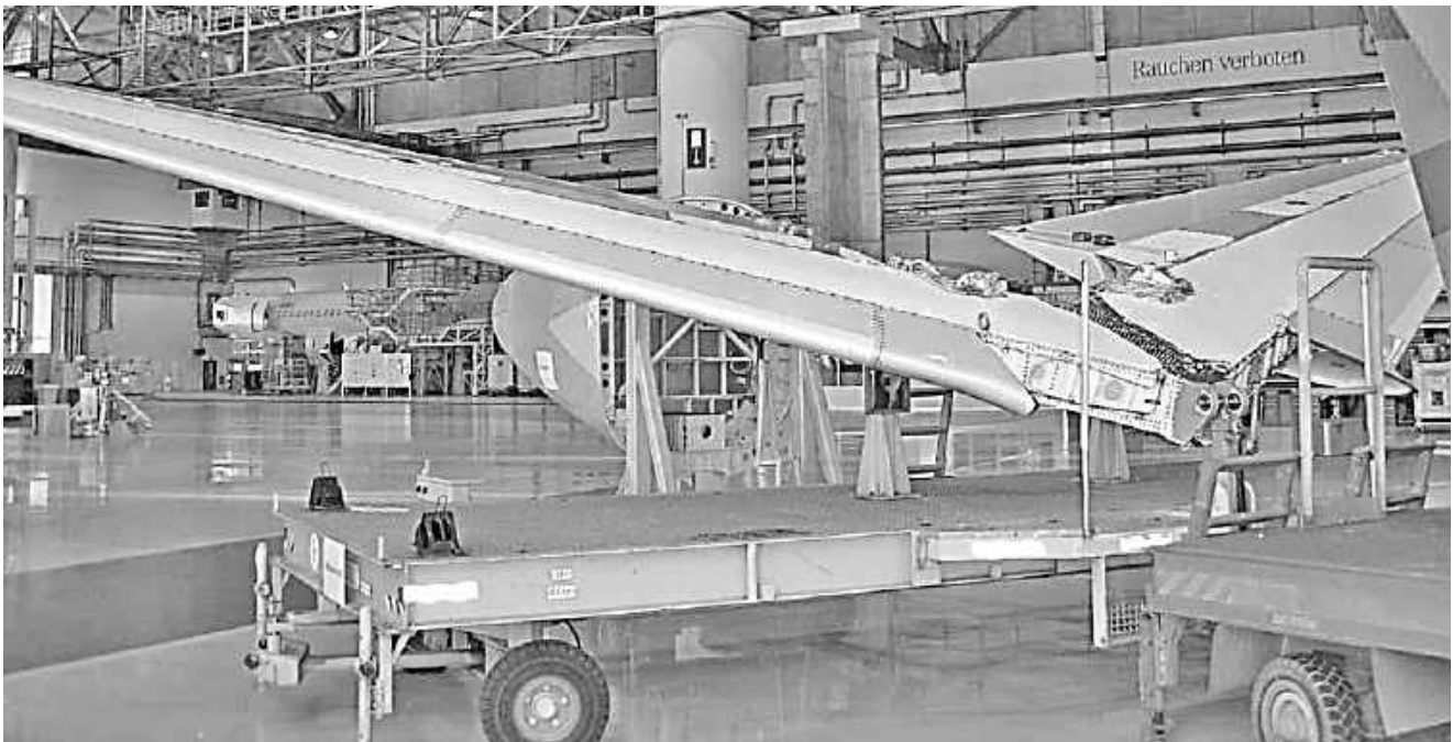
Рисунок 172 – Передній регульований по висоті вузол кріплення переставного горизонтального оперення літака А320neo (вигляд спереду) [169]
