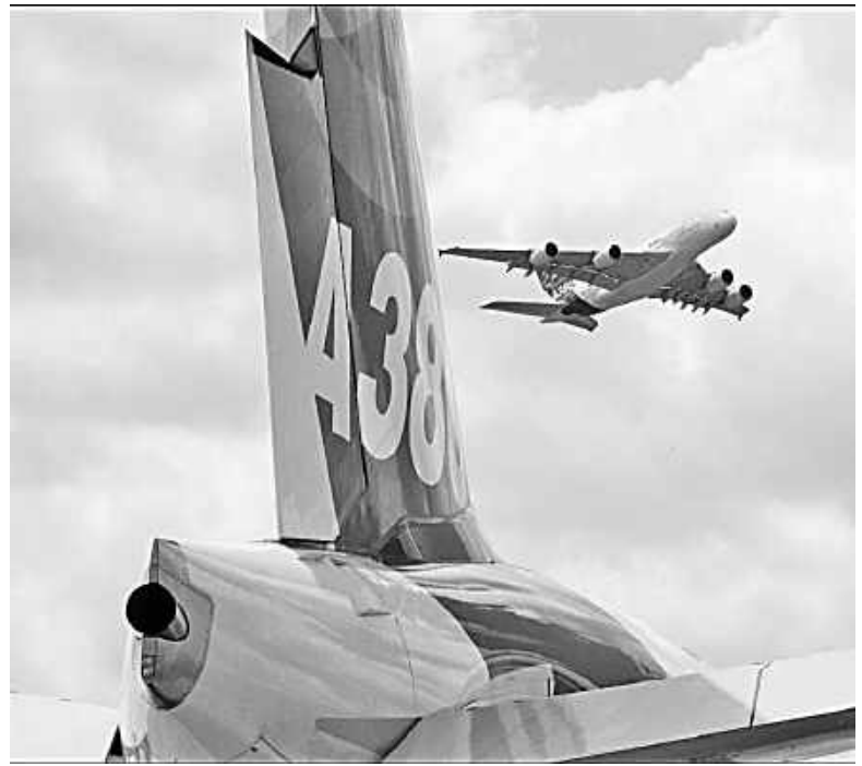
Рисунок 44 – Відсік ДСУ й вихлопний пристрій у хвостовій частині літака Airbus A380 [53, 54]
