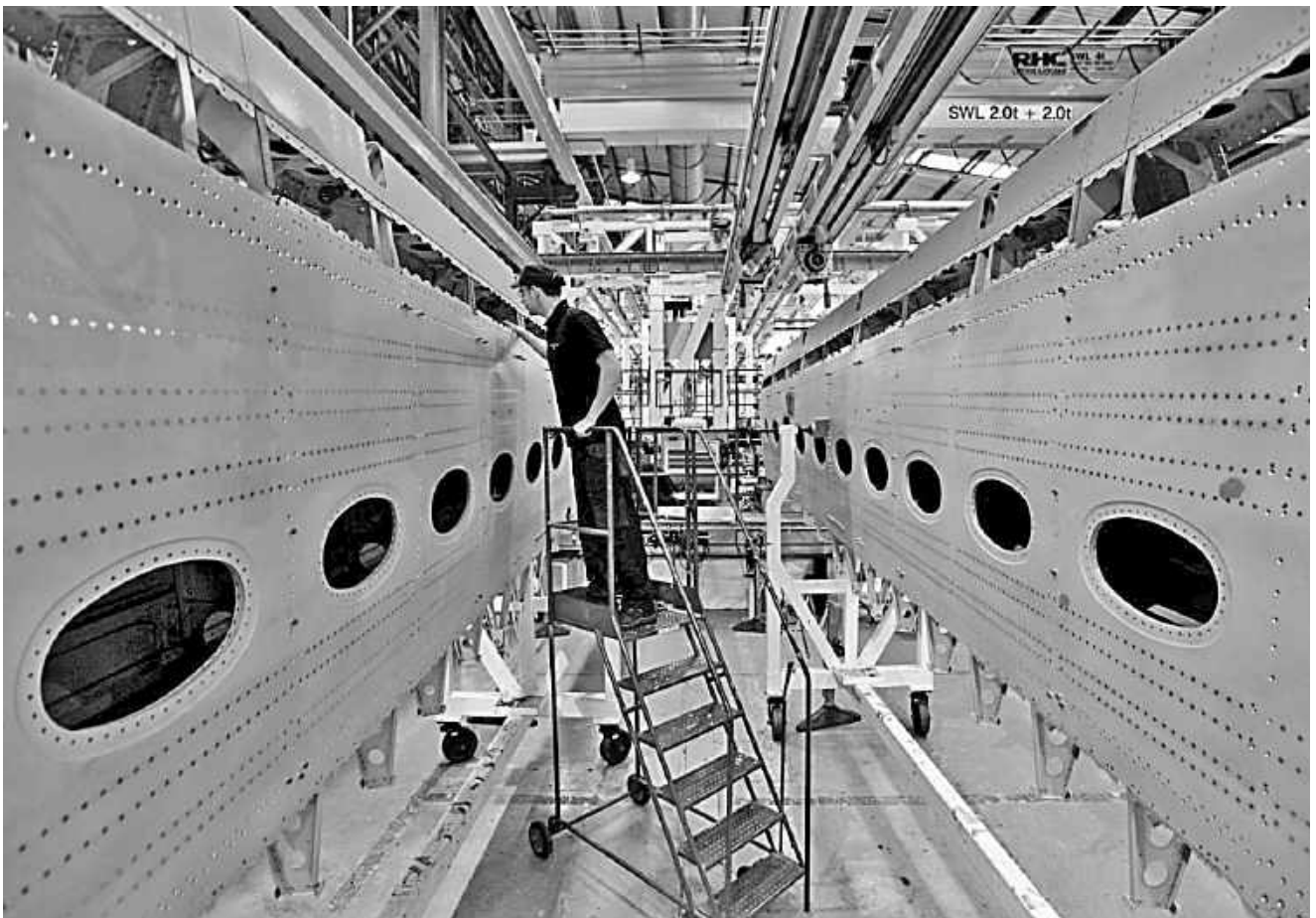
Рисунок 117 – Нижні панелі крила літака Airbus з люками-лазами [124]
