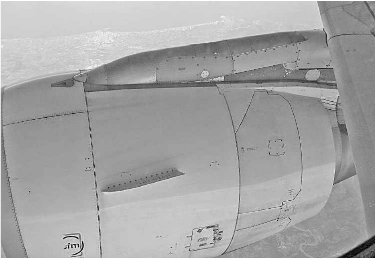
Рисунок 28 – Вигляд зони сполучення пілона двигуна з правою консоллю крила літака Airbus A320-214
