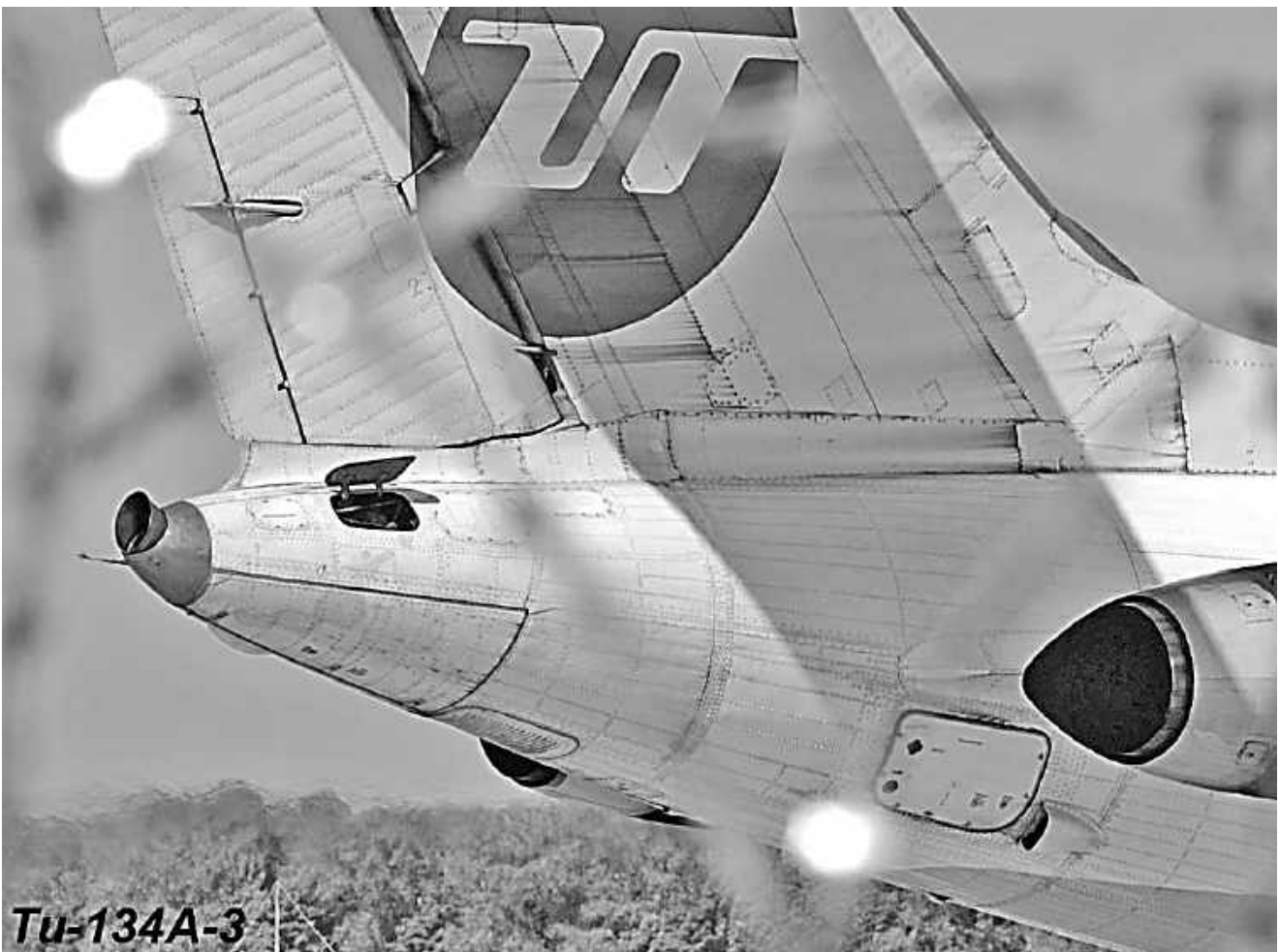
Рисунок 53 – Відкрита стулка повітрязабірника ДСУ в хвостовій частині літака Ту-134 [65]
