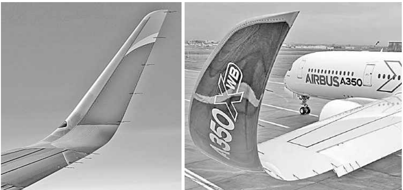
Рисунок 104 – Закінцівки крил типу «Blended Winglet» (Sharklets) літаків Airbus A320neo та Airbus A350XWB [106, 107]
