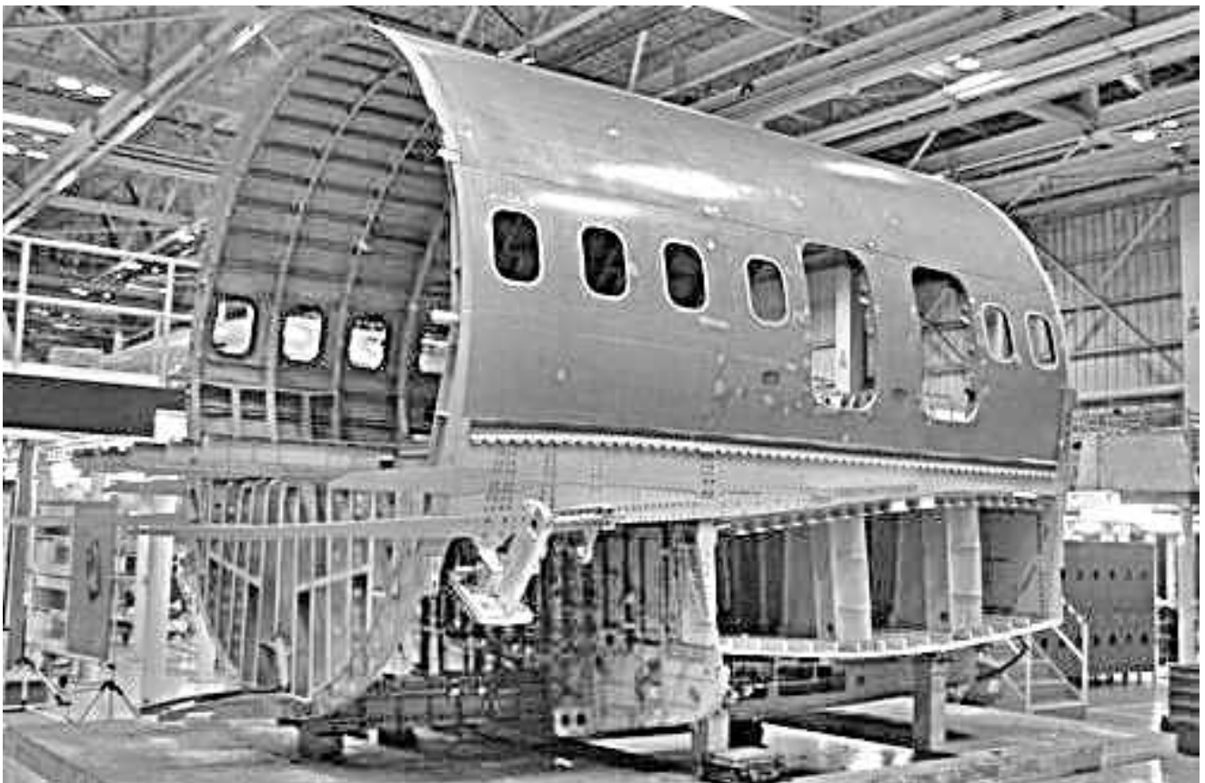
Рисунок 161 – Центроплан, ніша шасі й аварійні виходи на крило літака Boeing 737-800 [158]
