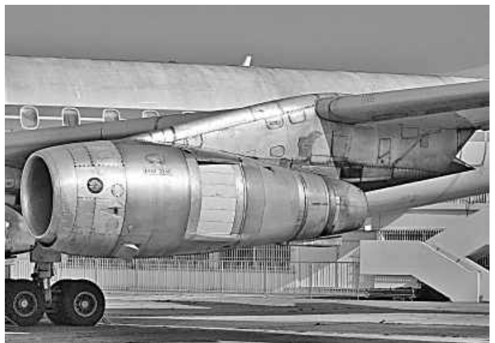
Рисунок 18 – Схема і зовнішній вигляд пілона двигуна літака Douglas DC-8: 1 – пілон; 2 – шумозаглушувальний насадок; 3 – двигун; 4 – гондола
