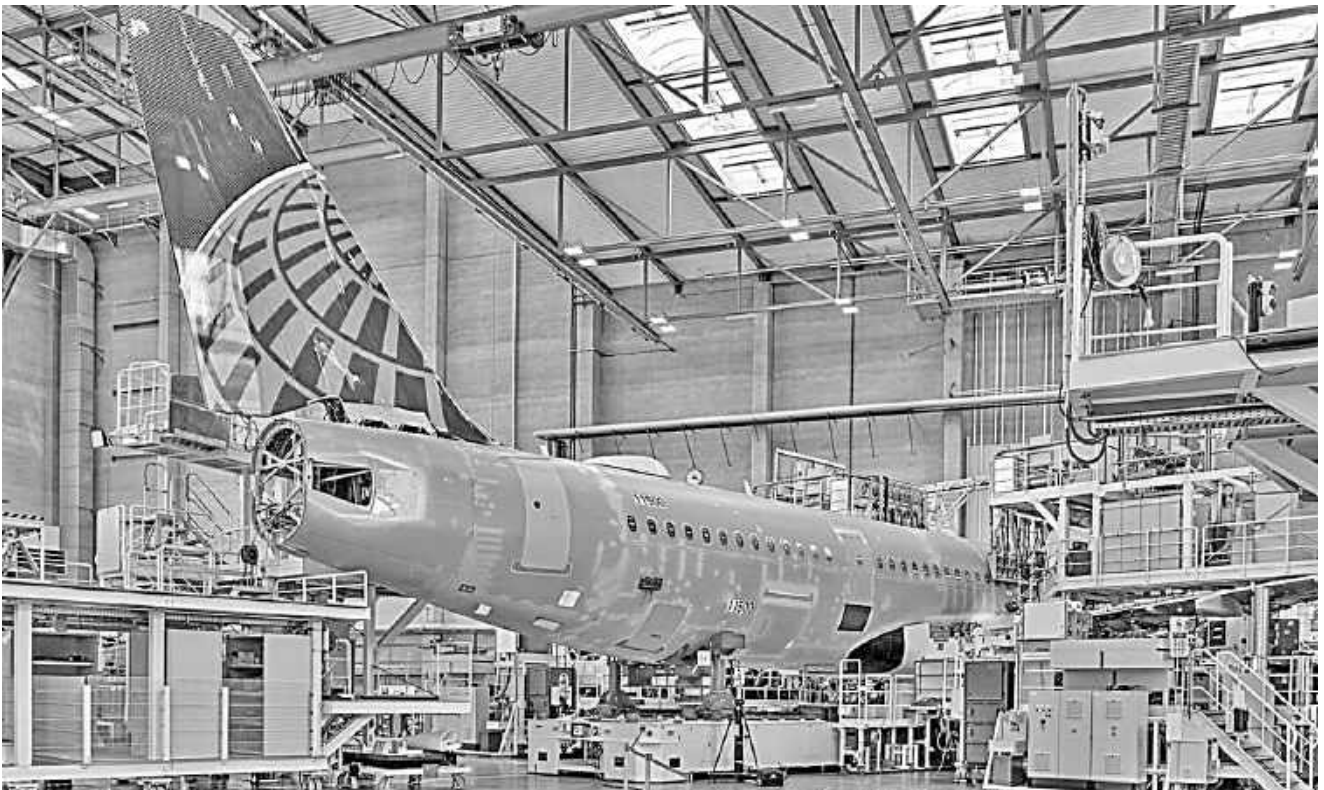
Рисунок 174 – Виріз у фюзеляжі літака Airbus A320 для встановлення переставного горизонтального оперення [171, 172]
