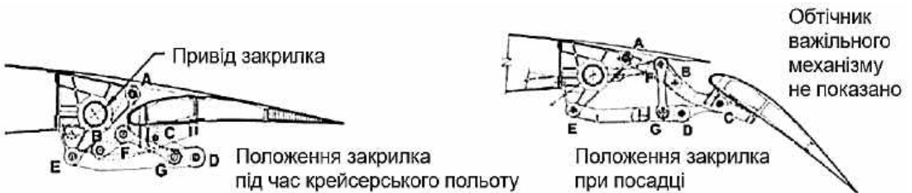
Рисунок 83 – Схема висувного однощілинного закрилка літака Boeing 767 [90]
