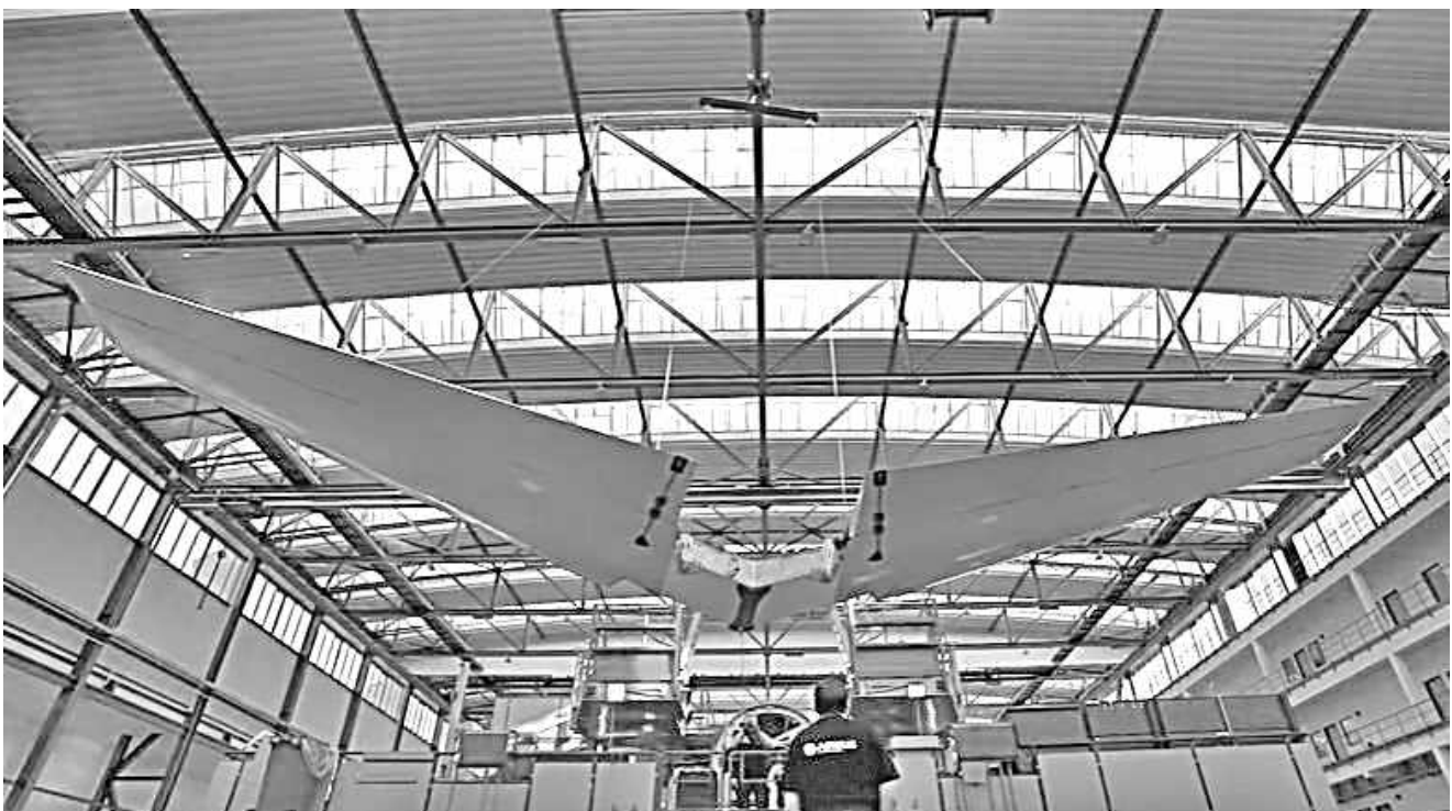
Рисунок 173 – Задні не регульовані по висоті вузли кріплення переставного горизонтального оперення літака А320neo (вигляд ззаду) (двома вертикальними відрізками виділено вузли навішування оперення на вісь його обертання) [170]
