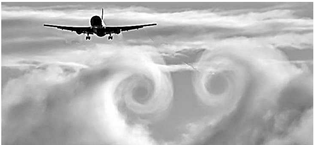
Рисунок 101 – Супутній струмінь (слід), що утворюється внаслідок прольоту літака через хмару [101]
