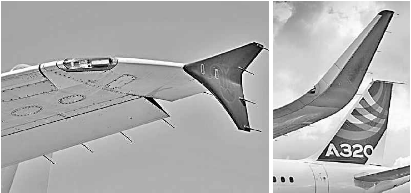
Рисунок 103 – Закінцівки крил типу «Wingtip Fence» літака Airbus A319 і типу «Blended Winglet» літака Airbus A320 (Sharklets) [104, 105]
