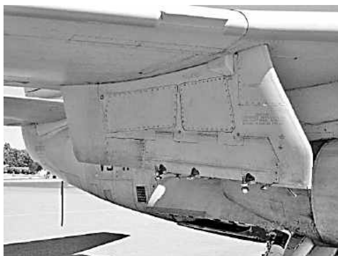
Рисунок 16 – Схема кріплення гондoli двигуна на вертикальному пілоні під крилом і вигляд вертикального пілона, під'єданого до консолі крила [22, 23]
